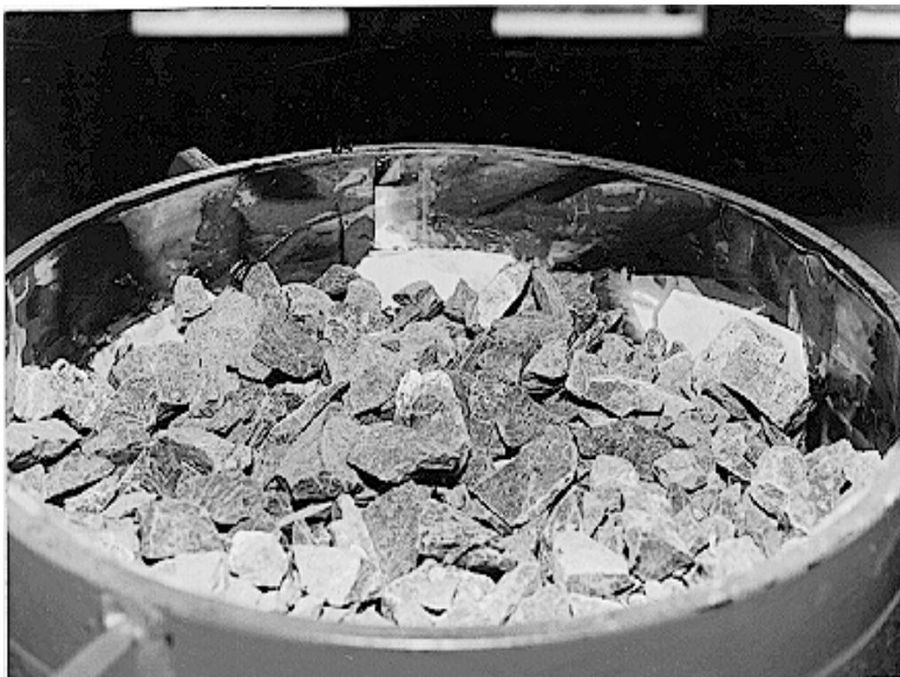
Figura 3.3 Detalle del material de balasto utilizado (D4-SCT) con placa antifriccionante.
