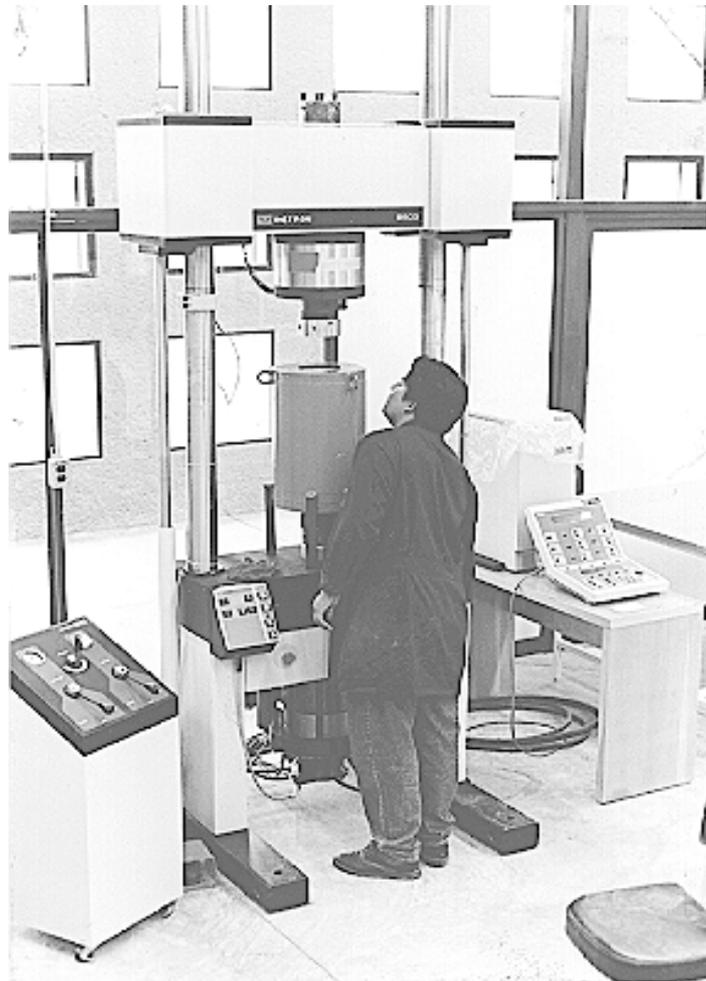
Figura 3.2 Marco de carga y muestra a ser ensayada en prueba de rotura de granos.
