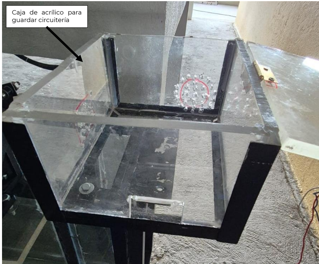
Figura 2.15 Caja de acrílico para guardar componentes electrónicos del sistema de generación de oleaje
