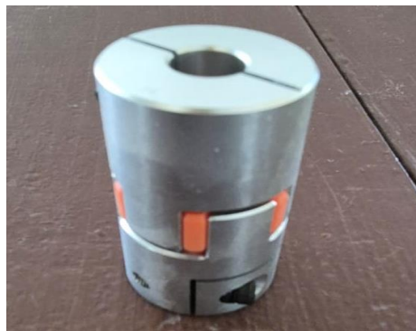
Figura 2.9 Cople de unión mecánica utilizado para el prototipo
