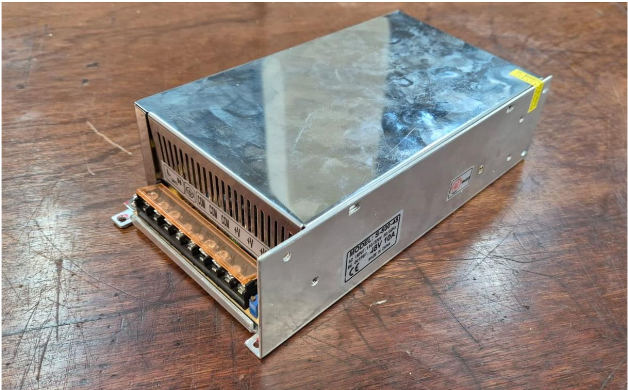
Figura 2.8 Fuente de alimentación de 48V y 10 a
