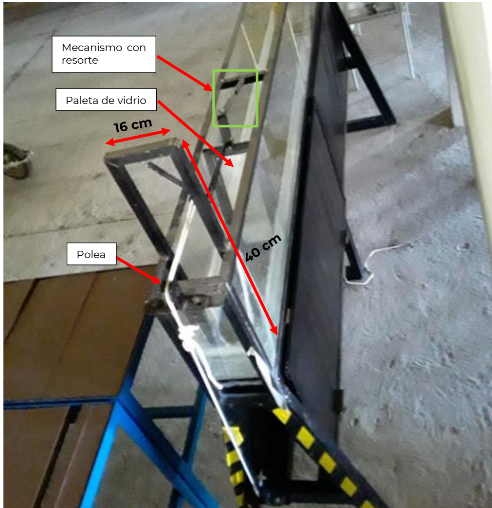
Figura 2.2 Mecanismo del canal de olas a escala del Laboratorio de Hidráulica Marítima del IMT
