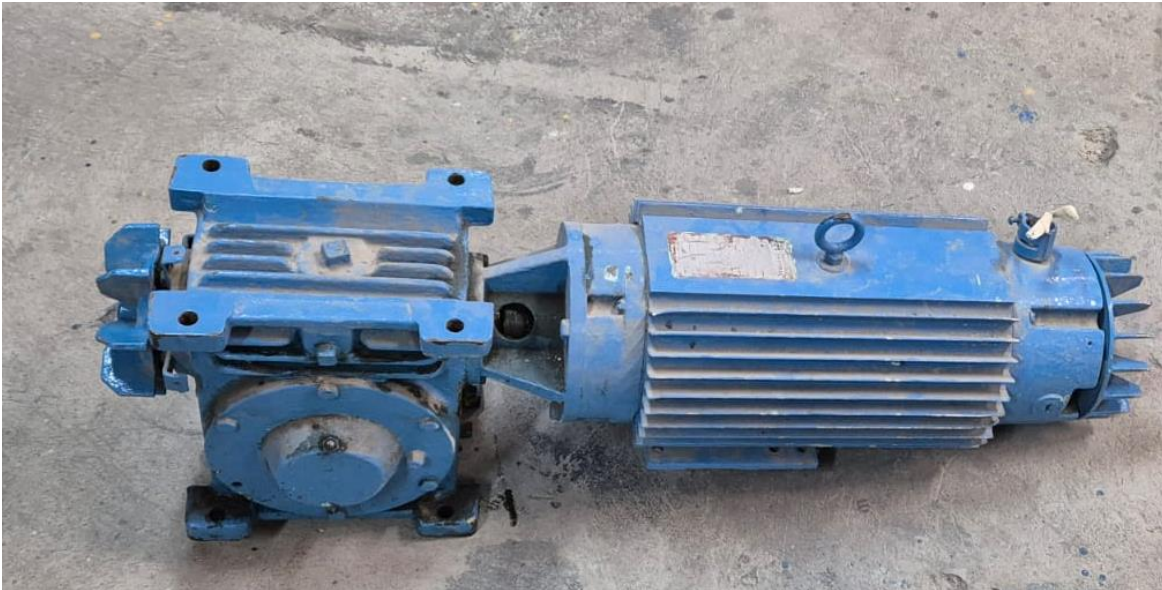
Figura 2.3 Motor de corriente alterna (AC) utilizado en el canal miniatura
