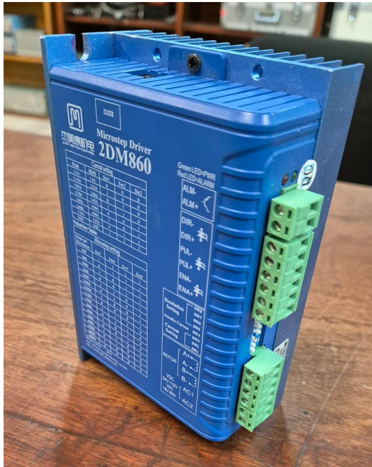
Figura 2.7 Driver 2DM860 utilizado en el prototipo
