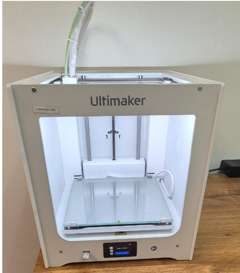
Figura 2.11 Impresora 3D utilizada para impresión de piezas
