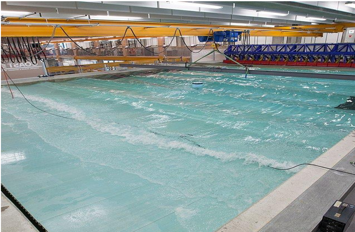
Figura 1.9 Ejemplo del funcionamiento de un generador de olas dentro de un laboratorio
