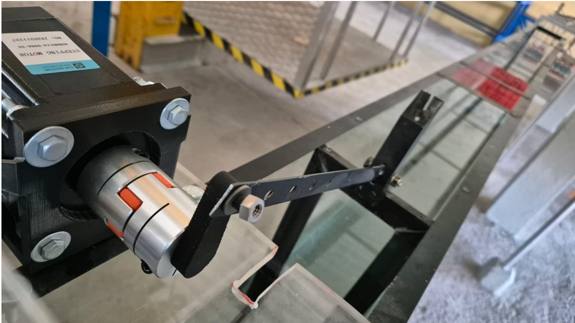
Figura 4.6 Ensamble de manivela con eslabón de paleta para segunda prueba
