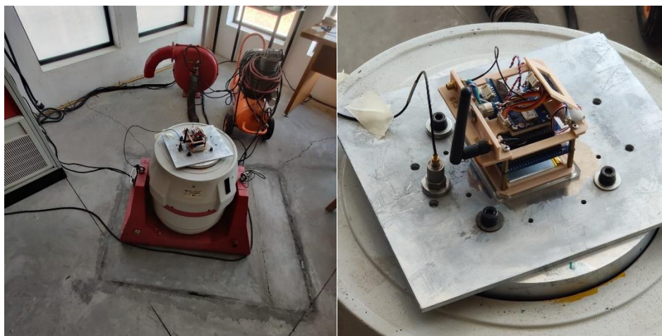
Figura 3.10 Pruebas de aceptación en mesa de vibraciones LDS
