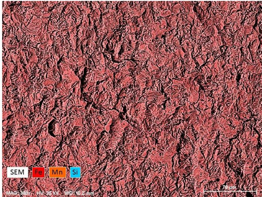
**Figura 3.5** Mapeo de composición química de la superficie de la rondana de acero al carbono, después del baño de limpieza y antes de depositar el recubrimiento
