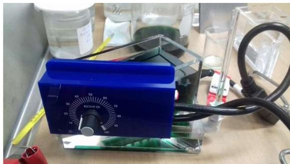
**Figura 2.4** Celda Hull de 267 ml con control de temperatura y agitación
