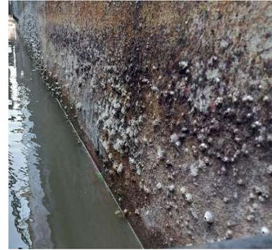
c) Corrosión en cascos de embarcaciones.
