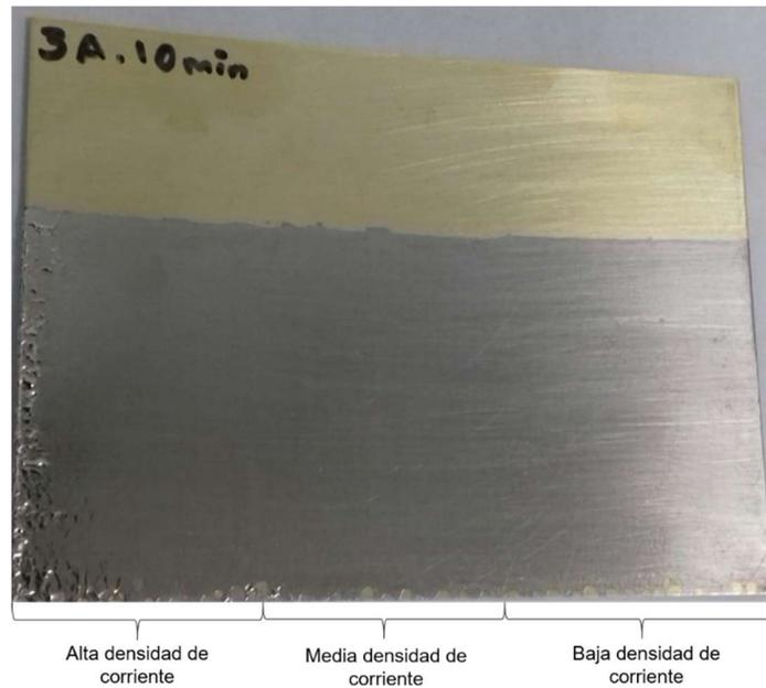
**Figura 3.1 Cátodo de Latón en el ensayo de 3 Amperes por 10 minutos**
