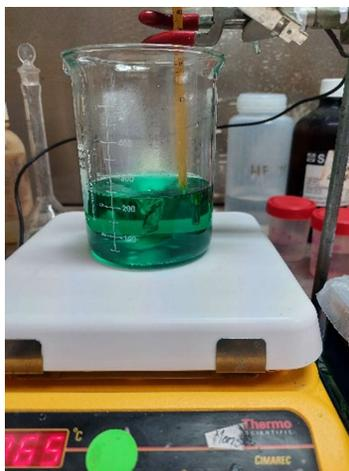
**Figura 2.3 Preparación de baño tipo Watts a 45°C y pH 4 para los ensayos en celdas Hull**
