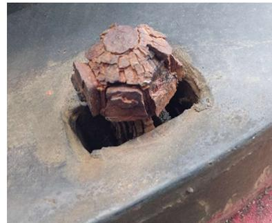
f) Corrosión en piezas de fijación de soporte para anclaje de embarcaciones
