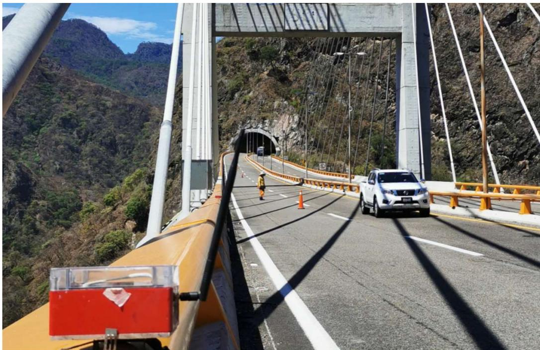
**Figura 2.9 Acelerómetro instalado en el cuerpo B, lado Durango**
