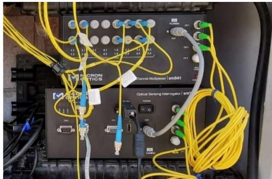
**Figura 2.2 Interconexión de interrogador y multiplexor en el puente El Carrizo**
