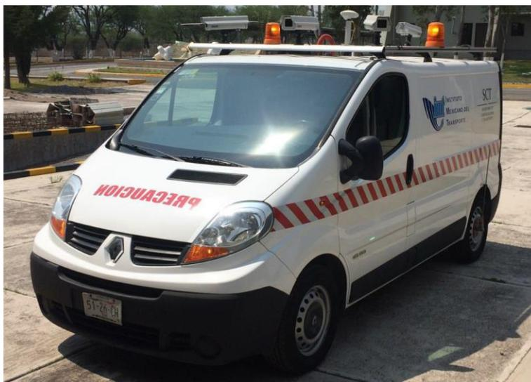
**Figura 1. Vehículo de inspección Hawkeye 2000 del IMT**
