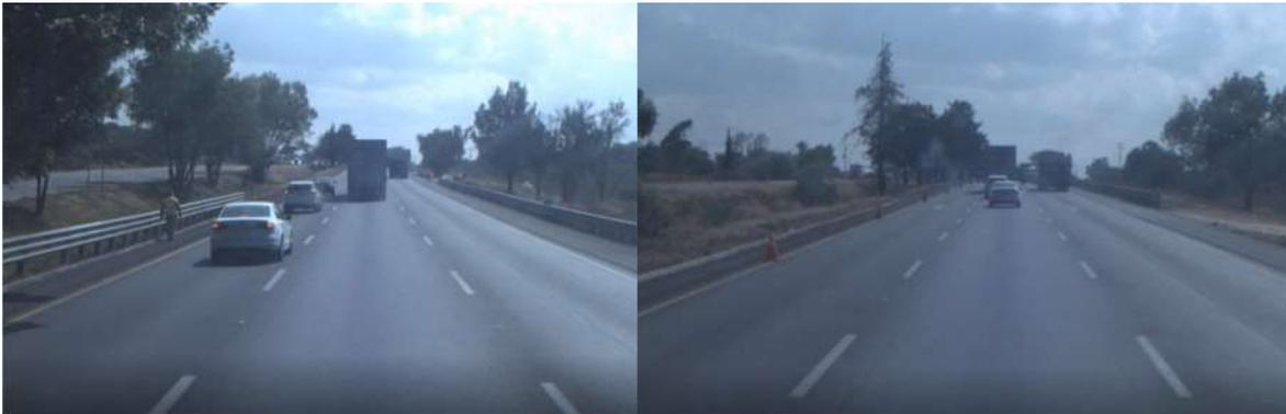
Nota: No se percibe señalamiento antes de la zona de obra ni de aviso ni de reducción de velocidad, se alcanza a ver a un trabajador en la imagen de la derecha en los márgenes del arroyo vial y en la imagen izquierda se percibe el inicio de los conos para delimitar la obra.
