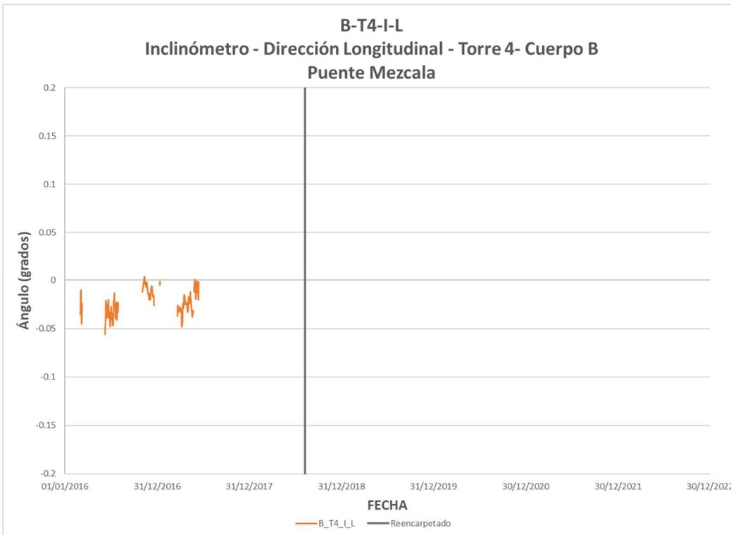
Figura 3.96 Seguimiento de la tendencia del inclinómetro B-T4-I-L
