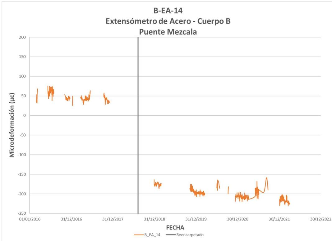
**Figura 3.73** Seguimiento de la tendencia del extensómetro B-EA-14
