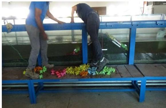
**Figura 1.5 Colocación de la coraza de la sección con elementos prefabricados**
