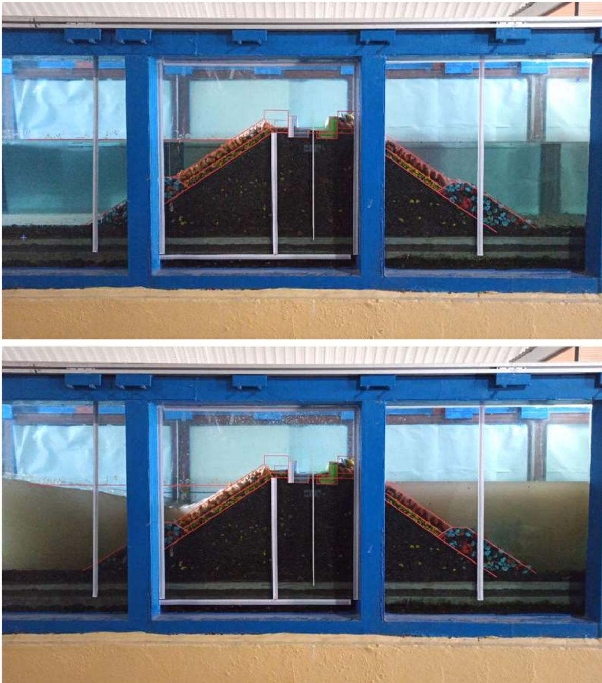
**Figura 5.3 Comparación de la turbidez del agua al inicio del ensayo (imagen superior) y al poco tiempo del inicio del ensayo (imagen inferior)**
