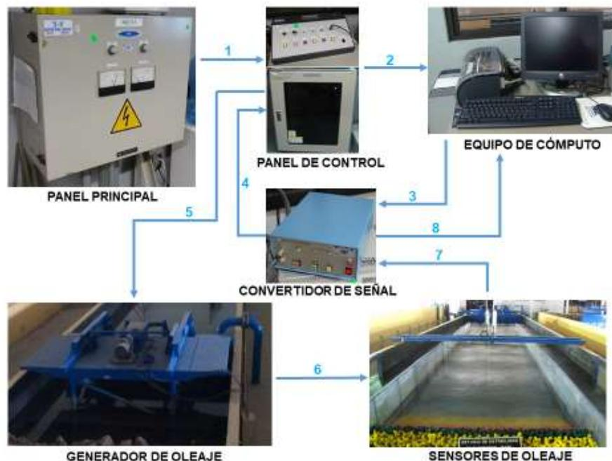
Figura 1.1 Equipo utilizado para la generación, medición y análisis de oleaje
