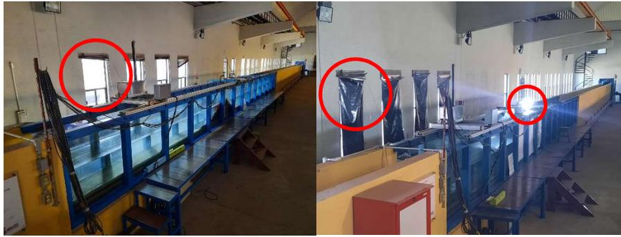
**Figura 2.2 Obstrucción de ventanas y colocación de reflector en el canal angosto**
