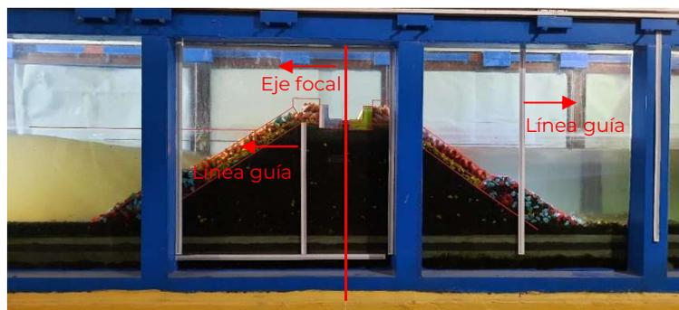
**Figura 2.5 Eje focal y líneas guías de la estructura**
