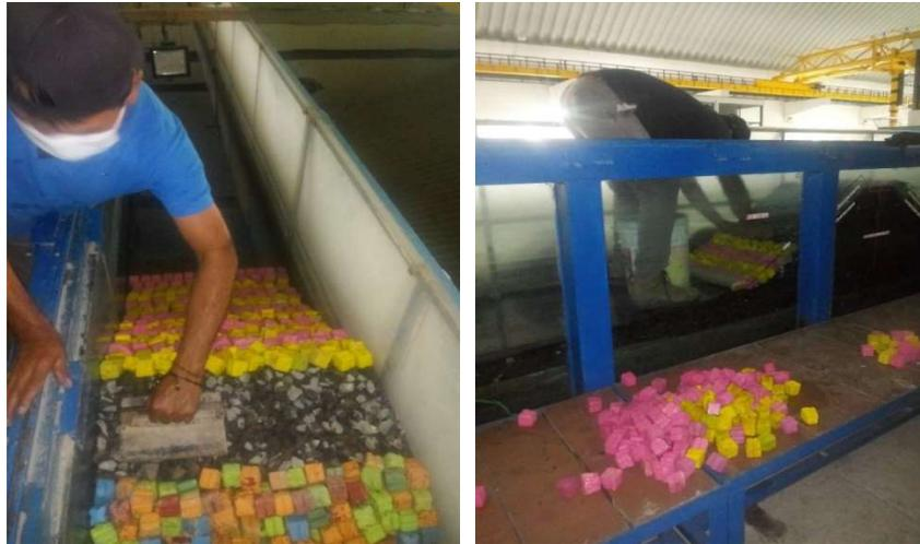
**Figura 1.6 Colocación de la coraza con Cubo ranurado**
