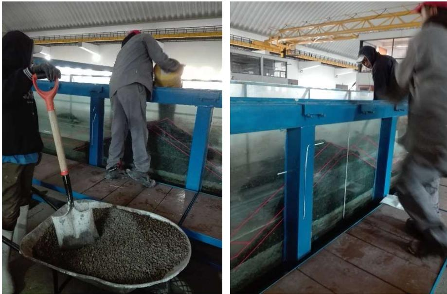
**Figura 1.4 Colocación de gravilla y grava (a la escala seleccionada) para la formación del núcleo y de la capa secundaria**
