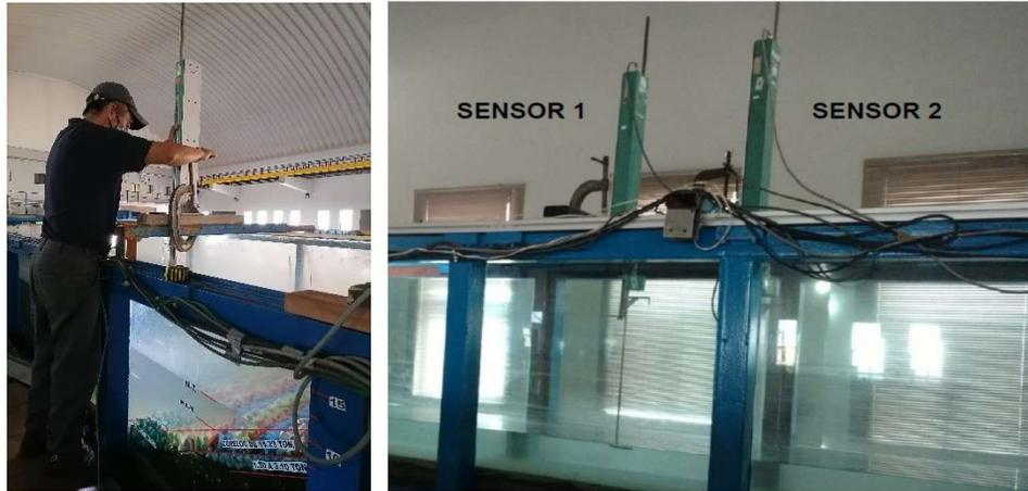
**Figura 1.2 Colocación de los sensores de medición de oleaje para los ensayos en modelo hidráulico en el canal de olas angosto**
