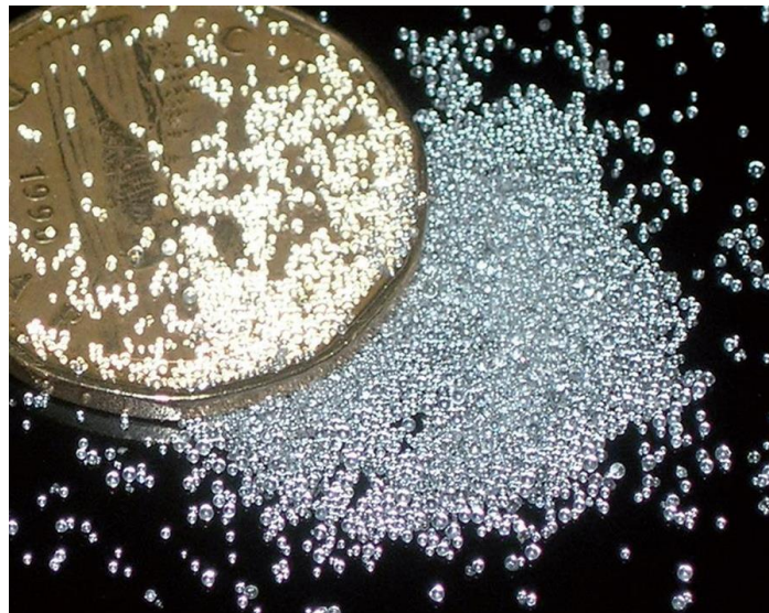
Figura 1.3 Microesferas de vidrio: incrementa la visibilidad de las marcas
