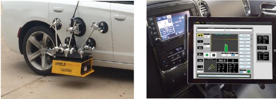
Figura 4.2 Equipo retroreflectómetro móvil
