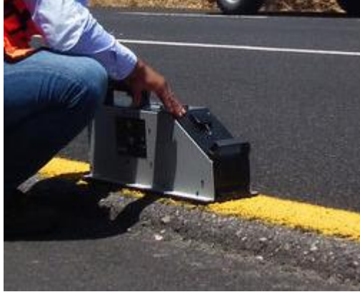
Figura 3.1 Determinación puntual del coeficiente de retrorreflexión
