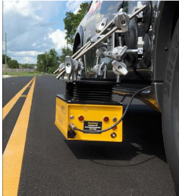
Figura 3.2 Equipo retroreflectómetro móvil Road Vista
