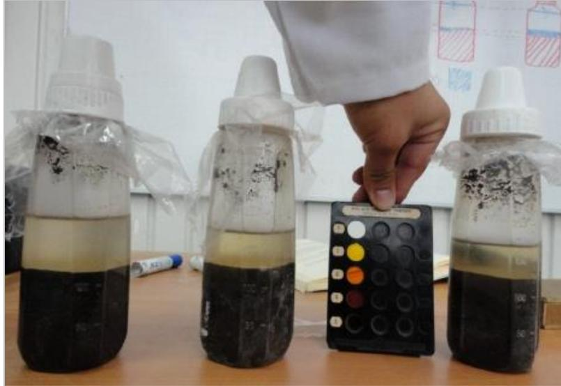
Figura 4.2 Comparación del color de las muestras con la tabla colorimétrica
