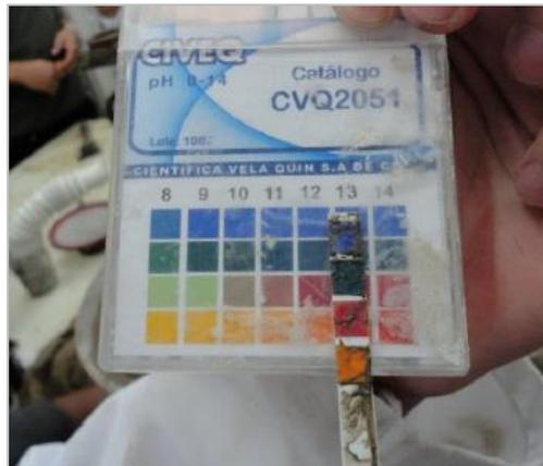
**Figura 4.4 Resultados del pH en el mortero fresco**
