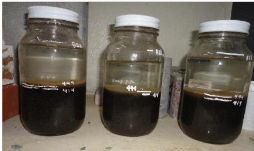
Figura 4.3 Resultados de la prueba de sedimentación
