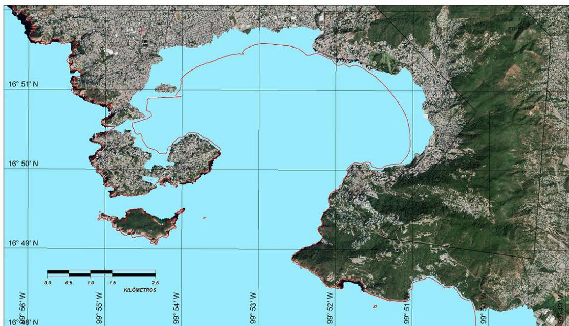
**Figura 4. 47. Superficie de inundación generada por el tsunami (Caso 24)**
