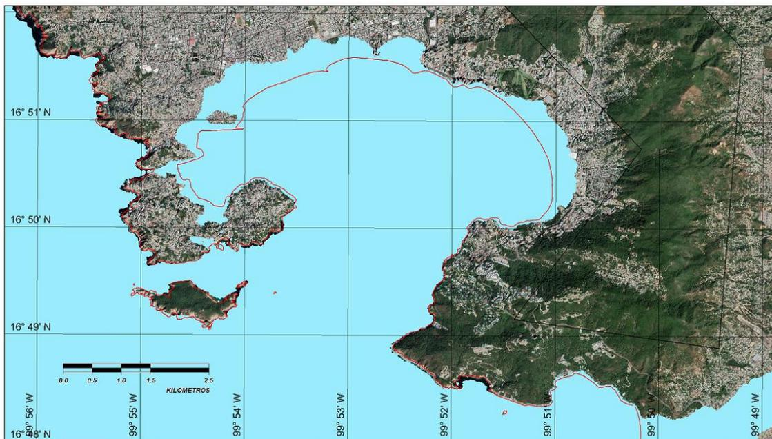
**Figura 4. 63. Superficie de inundación generada por el tsunami (Caso 32)**
