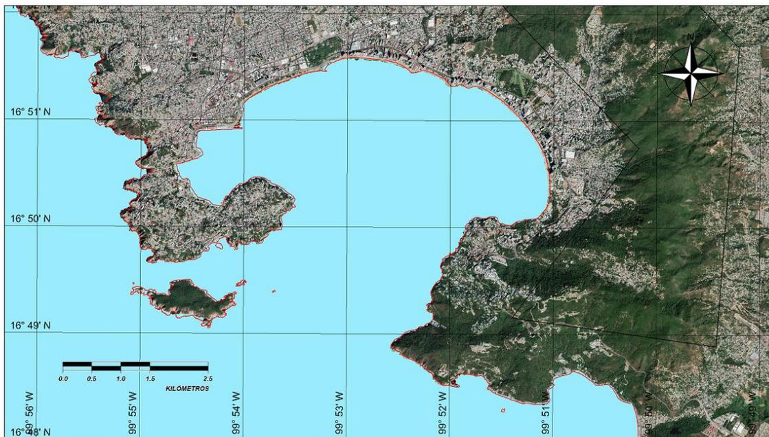
**Figura 4. 1. Superficie máxima de inundación generada por el tsunami (Caso 1)**
