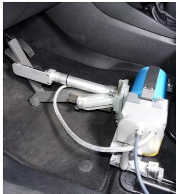
Figura 4.7 Actuador de freno de emergencia P-A1316 de *AB Dynamics*
