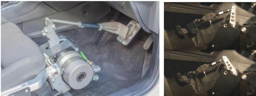
**Figura 4.5 Sistemas que integran motores eléctricos para el accionamiento del pedal de freno**
