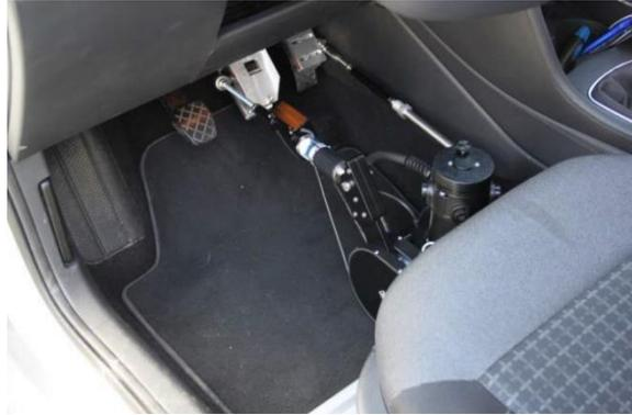
**Figura 4.8 Sistema robotizado combinado acelerador-freno CC800 de VEHI.CO**
