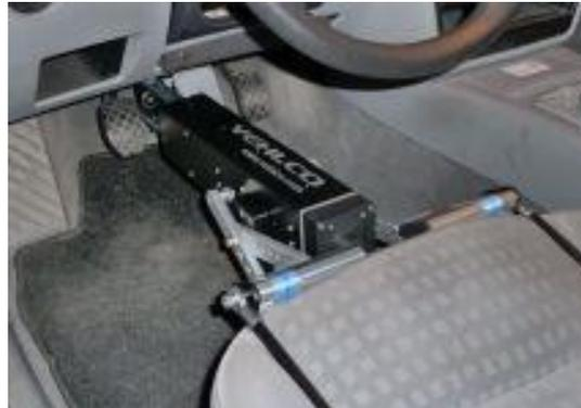
**Figura 4.9 Sistema de freno robotizado CB2100 de VEHI.CO**
