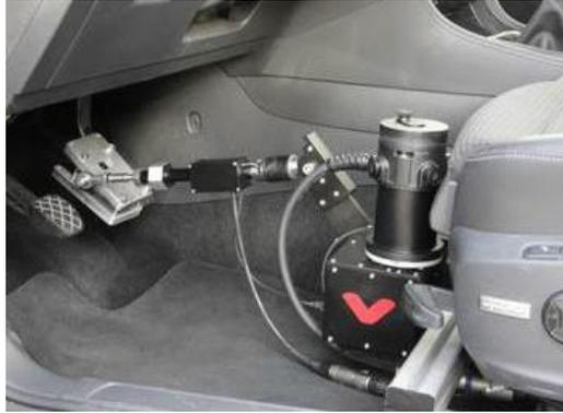
**Figura 4.10 Sistema de control de pedal multipropósito CP800 de VEHICO**
