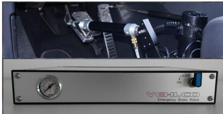
**Figura 4.11 Actuador de freno de emergencia sin riesgo de falla —*FAILSAFE*— de VEHICO**
