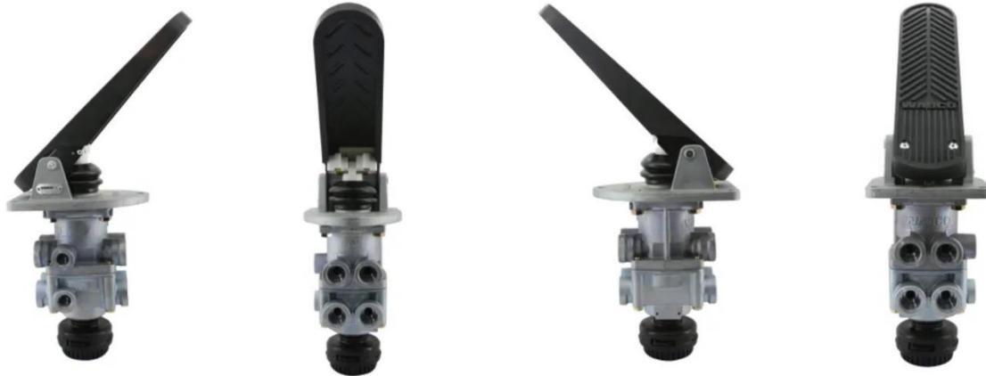
**Figura 5.2 Tipo 2 (tradicional) de pedal de freno encontrado en vehículos pesados o autobuses**
