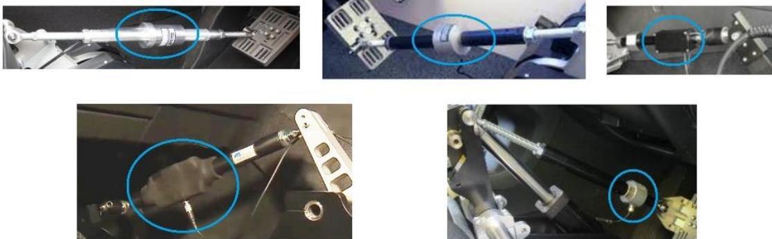
**Figura 5.15 Ejemplos de transductores de fuerza y/o celdas de carga no intrusivos al pedal de freno**
