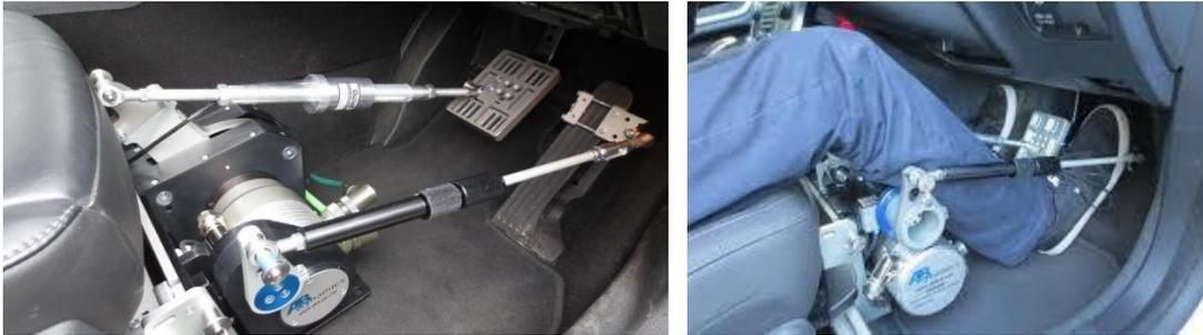
Figura 4.6 Sistema combinado de control de acelerador y freno —CBAR— de *AB Dynamics*
