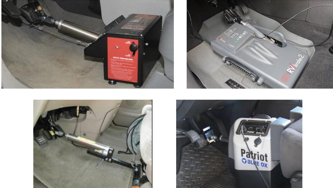
Figura 4.13 Sistema de frenado automatizado instalados en vehículos no tripulados y arrastrados por otro vehículo
