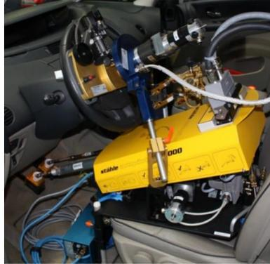
**Figura 4.1 Sistema robotizado para control de pedales y volante en un vehículo**
