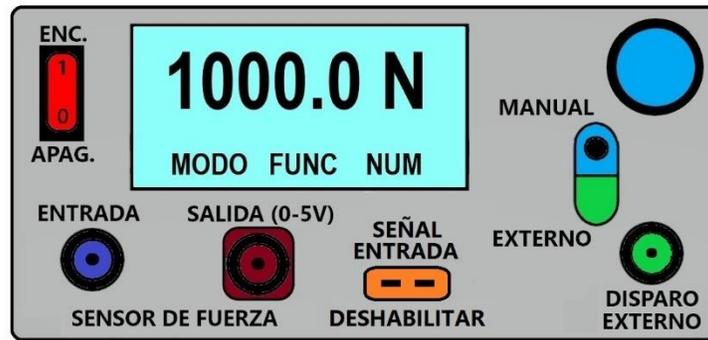
**Figura 5.17** Diseño conceptual del sistema de frenado automatizado. Unidad de Control y visualización
