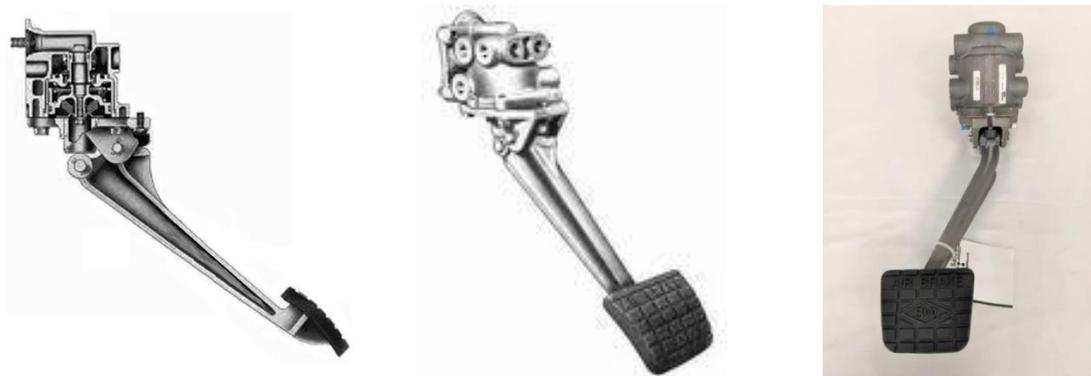
Figura 5.1 Tipo 1 de pedal de freno encontrado en vehículos pesados o autobuses
