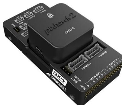
Figura 3.8 Controlador de vuelo pixhawk2<sup>15</sup>.
