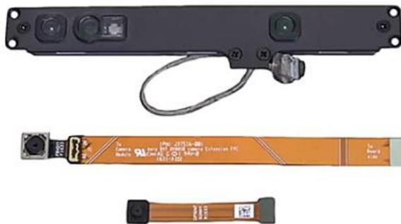
Figura 3.10 Cámara Intel RealSense LR200<sup>17</sup>.
