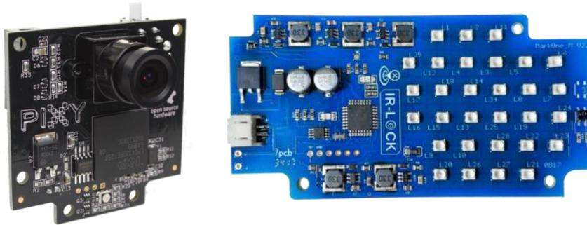
Figura 3.15 Sensor IR-LOCK y MarkOne Beacon v2.0.
