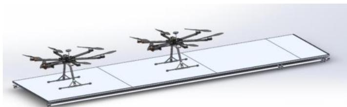
**Figura 3.19 (a)** Plataforma para despegue y aterrizaje.
