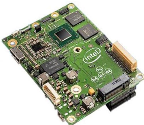
Figura 3.9 Computadora Intel Aero<sup>16</sup>.
