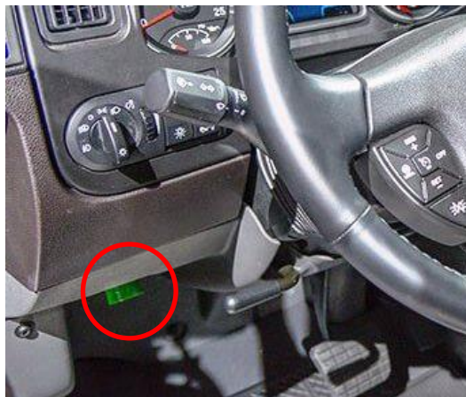
Figura 3.1 Ubicación del puerto de diagnóstico de 9 pines en camión International
