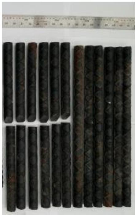
**Figura 2.3 Varillas de cortadas y biseladas.**
