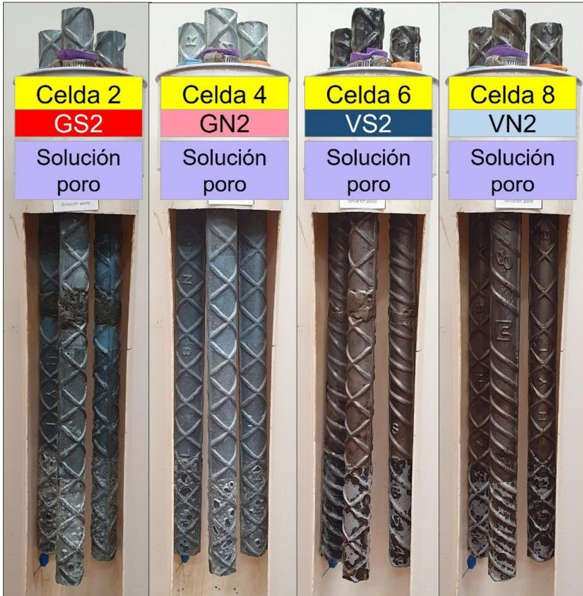
**Figura 3.2 Menor cantidad de productos de corrosión en las celdas sin cloruros.**
