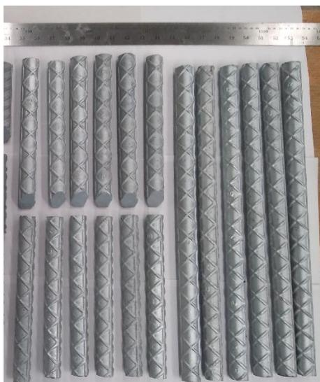
**Figura 2.4 Varillas galvanizadas.**
