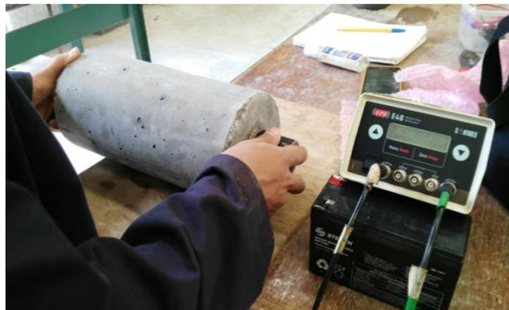
**Figura 2.2** Ensayo de velocidad de pulso ultrasónico (VPU)
