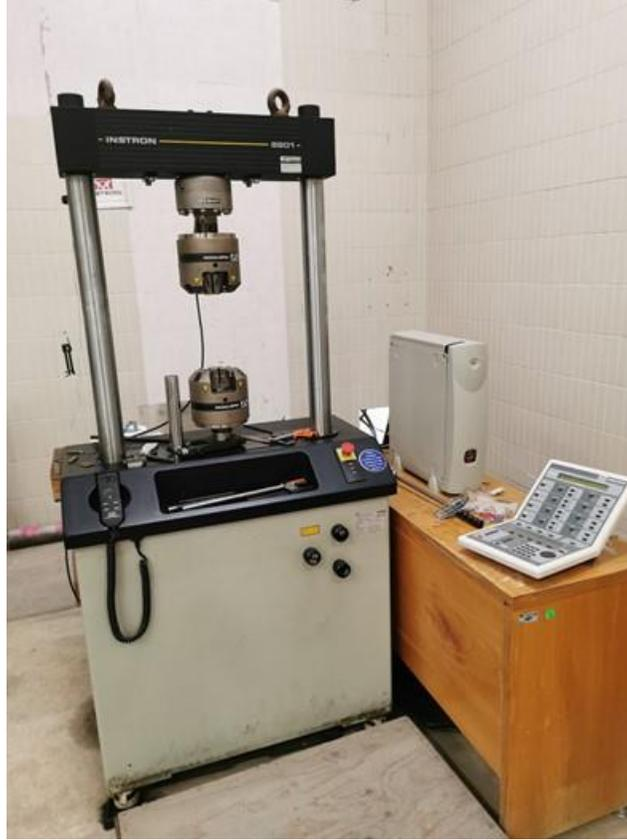
Figura 2.5 Equipo para ensayo de resistencia a la compresión
