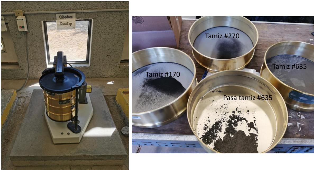
Figura 3.1 Cribadora y tamices utilizados
