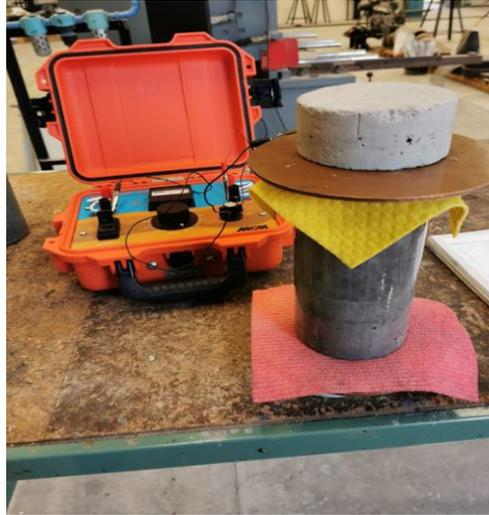
Figura 2.3 Ensayo de resistividad eléctrica
