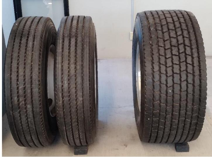
**Figura 1.1 Comparación del arreglo dual contra llanta de base ancha**
