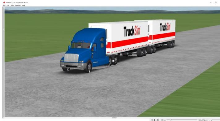
Figura 2.11 Animación de la configuración T3-S2-R4 generada por el programa de simulación
