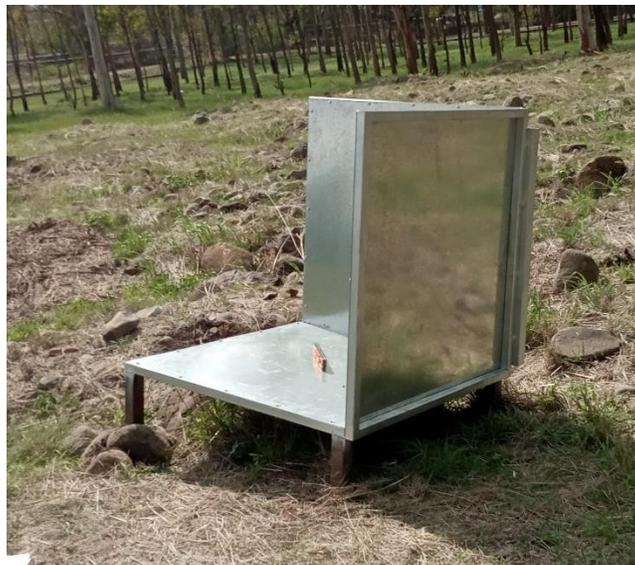
Figura 3.1 Antena reflejante previamente a ser instalada
