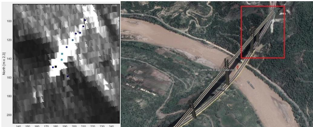
**Figura 4.3 Puntos reflejantes del puente Mezcala**
