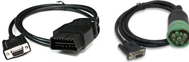
**Figura 3.10** Cable para conector OBD-II (común en vehículos ligeros) y conector de 9 pines J1939 (frecuente en vehículos pesados), izquierda y derecha, respectivamente
