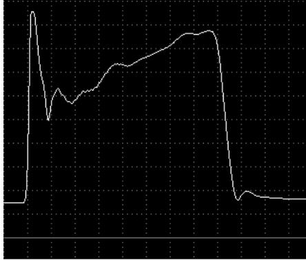
Figura 2.9 Señal de medidor de flujo de aire
