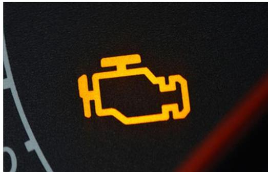
Figura 2.4 Indicador de chequear el motor
