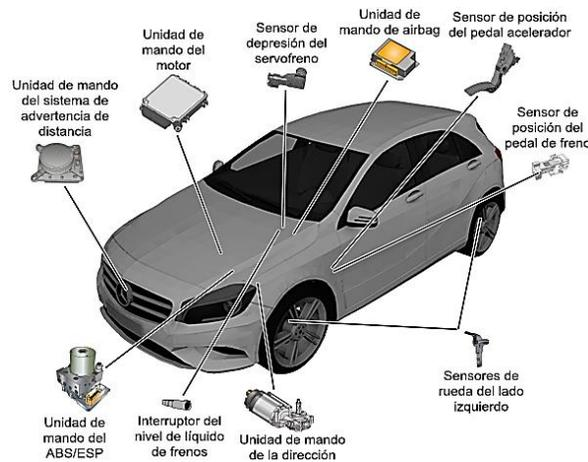
**Figura 2.14 Elementos del sistema ESP [7]**
