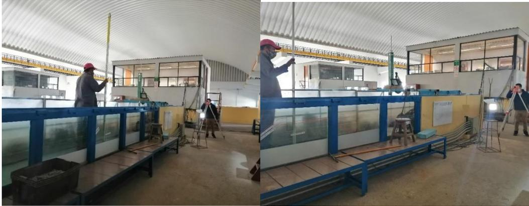
**Figura 5.2 Trazo y nivelación de la losa de fondo y sección transversal a ensayar**
