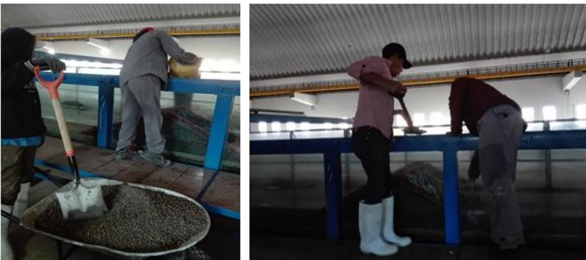
Figura 5.7 Construcción de capas de la sección transversal de morro a ensayar
