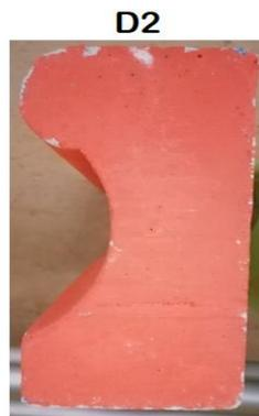
**Figura 6.1 Deflector diseñado geoméricamente medinte la rutina computacional generada**
