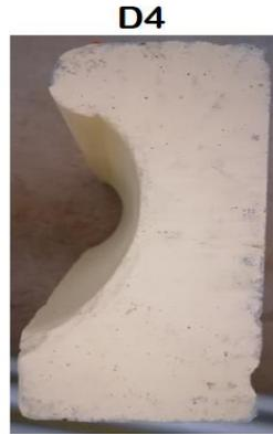
**Figura 6.2 Deflector diseñado con las características del proyecto de la prolongación del rompeolas de Ensenada, B. C**
