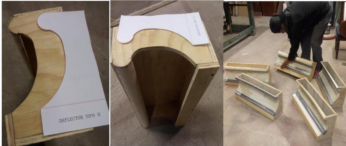
Figura 5.4 Proceso de hechura de las cimbras de los deflectores de oleaje a ensayar
