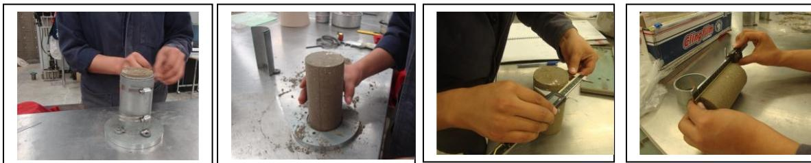
**Figura 2.4. Enrase y toma de dimensiones y peso de la muestra**
