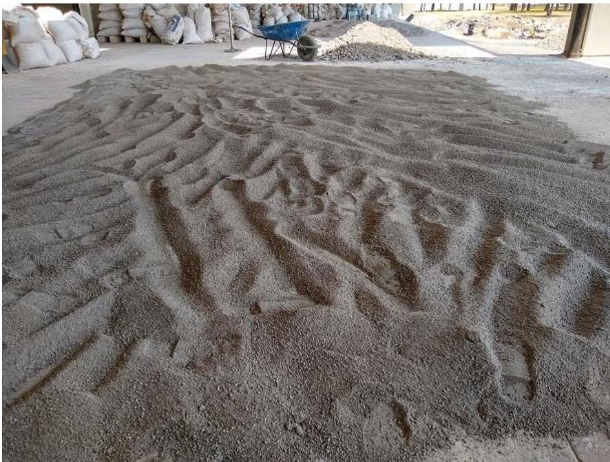
**Figura 1.5. Secado al aire de uno de los materiales**
