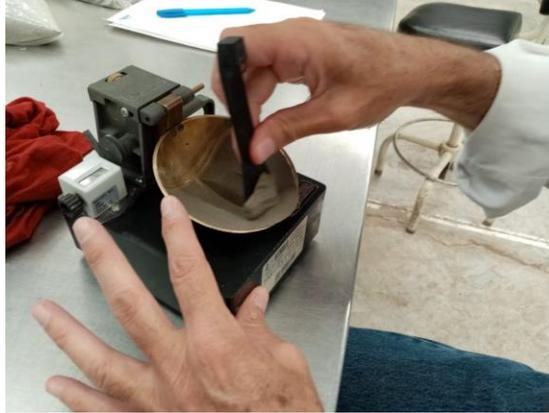
Figura 5.5 Manera de hacer la ranura para determinar el límite líquido.
