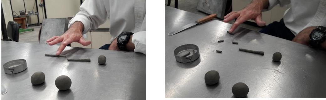
Figura 5.8 Manera de formar el rollito de suelo para determinar su límite plástico
