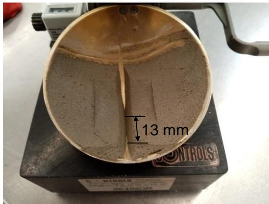
Figura 5.7 Dispositivo de límite líquido después que la ranura ha cerrado.
