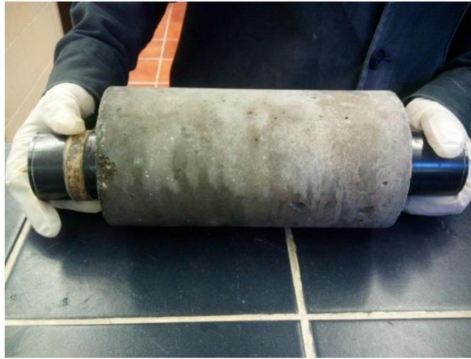
Figura 2.2 Ensayo de velocidad de pulso ultrasónico (VPU)
