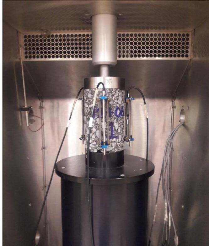
**Figura 3.5 Montaje de LVDTs**
