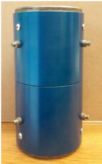
Figura 3.3 Probeta metálica para verificación del sistema de medición
