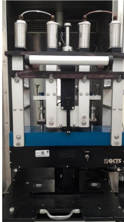
Figura 4.1 Aparato de carga de prueba de fatiga
