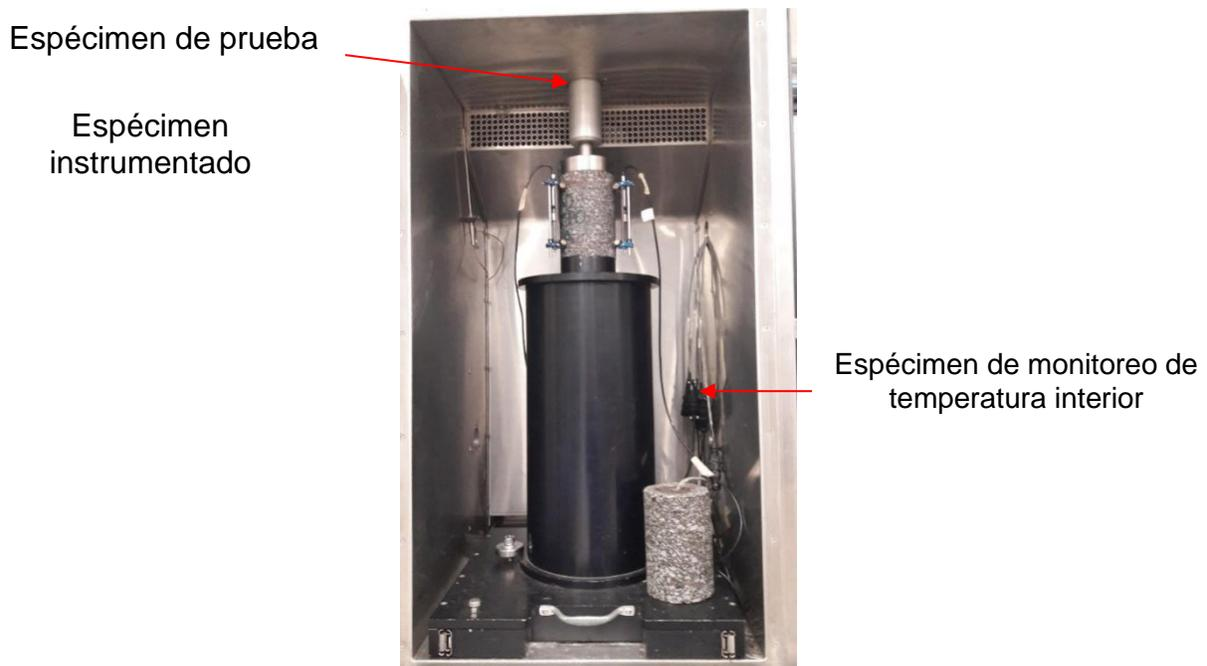
**Figura 2.6 Instrumentación y acondicionamiento de los especímenes de prueba**
