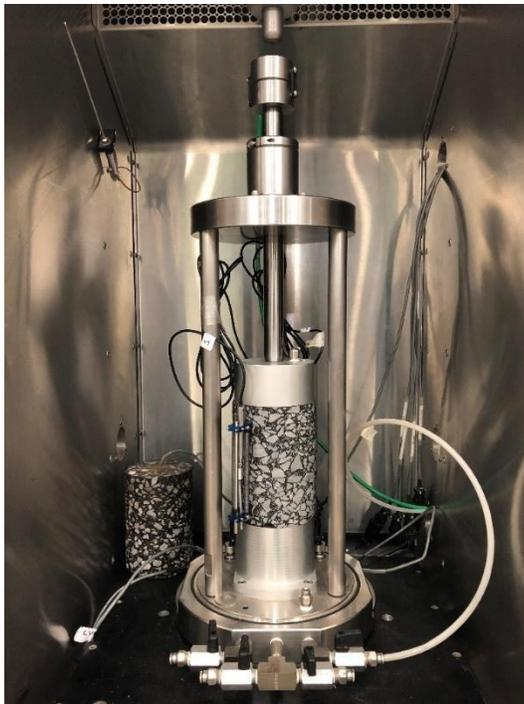
**Figura 3.6 Montaje de LVDTs**
