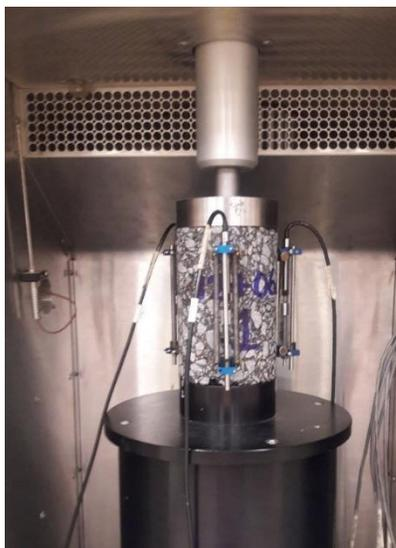
**Figura 2.5 Montaje de LVDTs**
