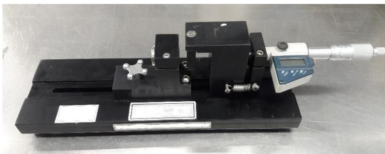
**Figura 2.4 Calibrador para sensor de deformación (LVDT)**
