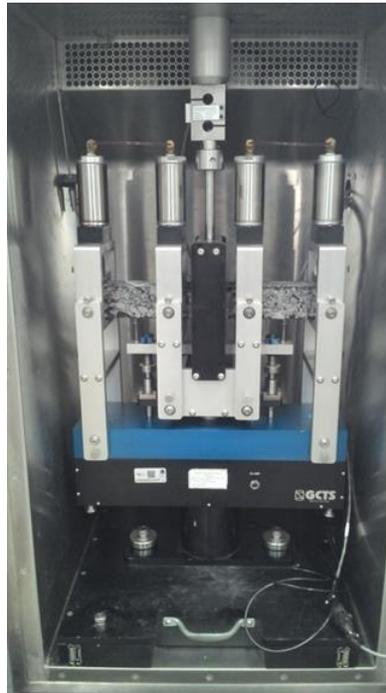
**Figura 4.7 Montaje de la prueba de fatiga**
