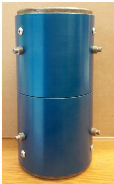
Figura 2.3 Probeta metálica para verificación del sistema de medición
