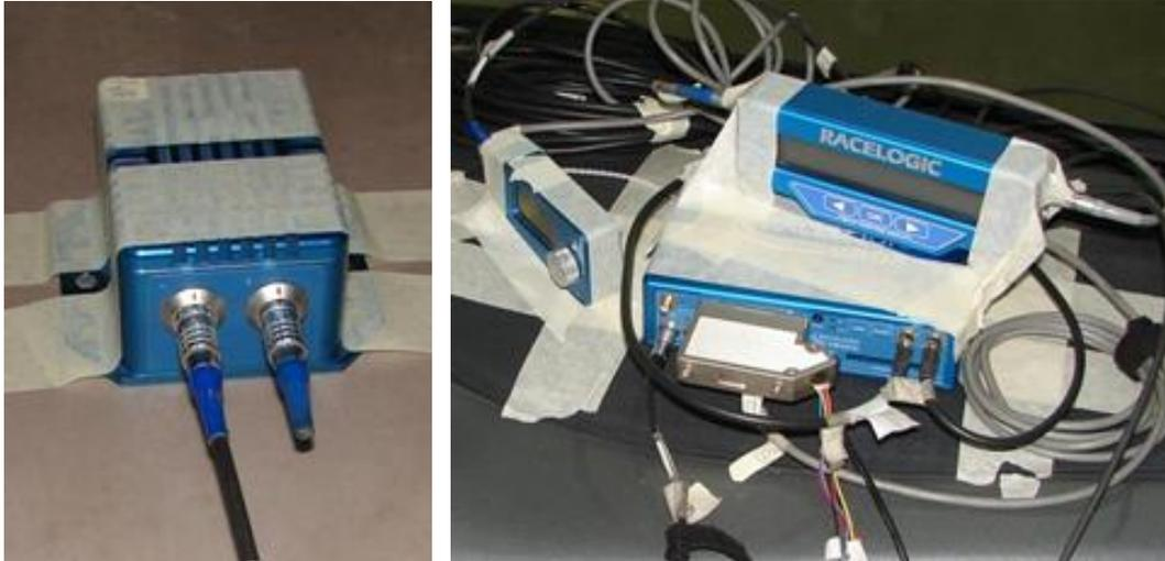
**Figura 2.6 Unidad de medición inercial (izq.) y sistema de control y almacenamiento (der.)**
