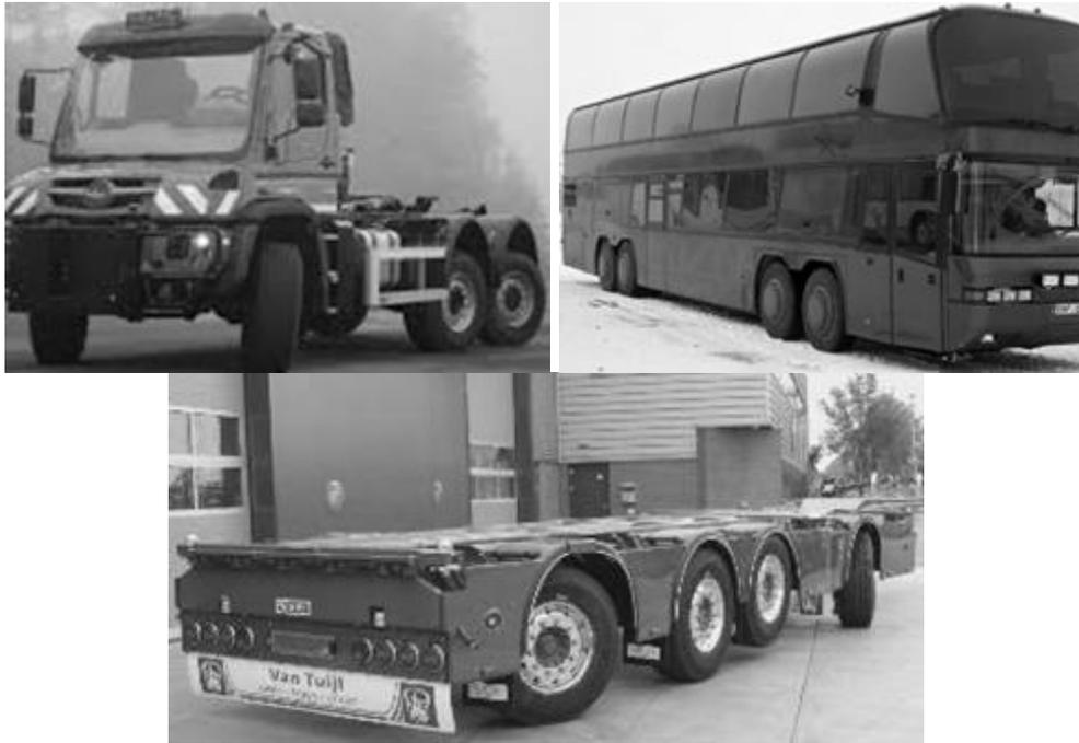
**Figura 1.11 Ejemplos de vehículos pesados con ejes virables**
