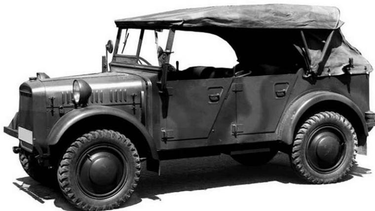
**Figura 1.5 Vehículo Stoewer R180 de 1936 con cuatro ruedas direccionables**
