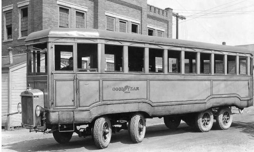
**Figura 1.4 Autobús con dos ejes frontales direccionables de 1922**
