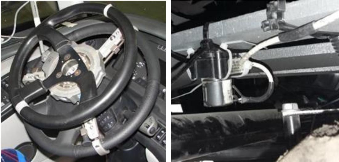
**Figura 2.5 Sistema de medición ángulo del volante (izq.) y potenciómetro en eje virable (der.)**
