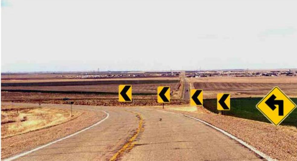
**Figura 4.7 Colocación de señalamiento preventivo para curva horizontal con trazado confuso.**
