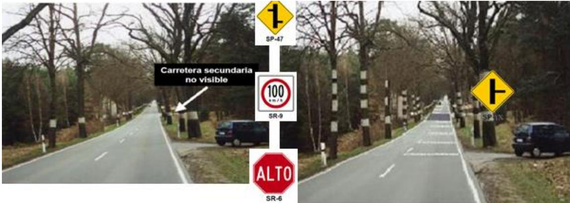
Figura 4.5 Ejemplo representativo para minimizar el impacto en un acceso.
