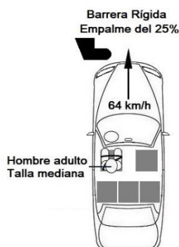
Figura 1.49 C-IASI. Choque frontal con empalme del 25% contra barrera lateral rígida
