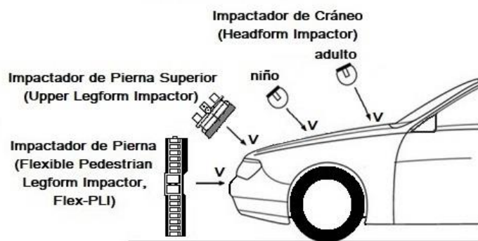
Figura 1.26. Euro NCAP. Pruebas de impacto en peatones (cabeza y pierna).
