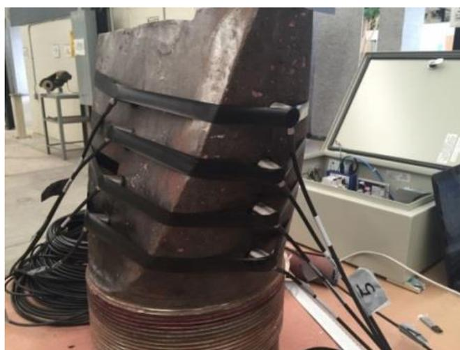
**Figura 1.12 Prueba de emisiones acústicas según ASTM-F2174.**
