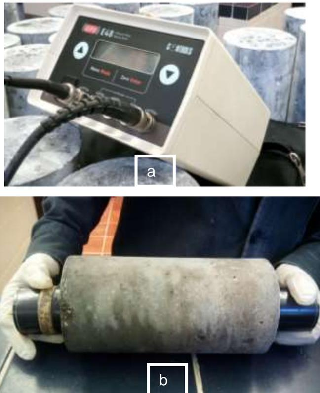
**Figura 2.1. Ensayo de VPU: a) equipo VPU con sus respectivas conexiones; b) posición de los transductores en la muestra y c) determinación de la velocidad de pulso.**
