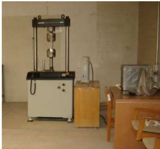
Figura 2.6 Máquina servo hidráulica utilizada para los ensayos de resistencia a la compresión.
