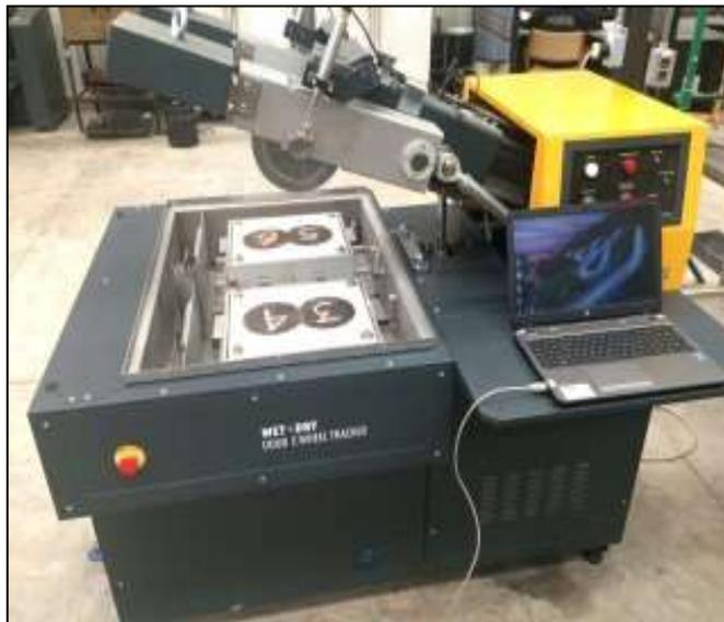
**Figura 1.1** Equipo de rueda cargada de Hamburgo propiedad del IMT.
