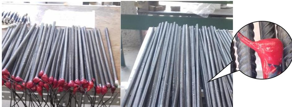
**Figura 2.2 Preparación de varillas de acero al carbono y conexión eléctrica para pruebas electroquímicas**
