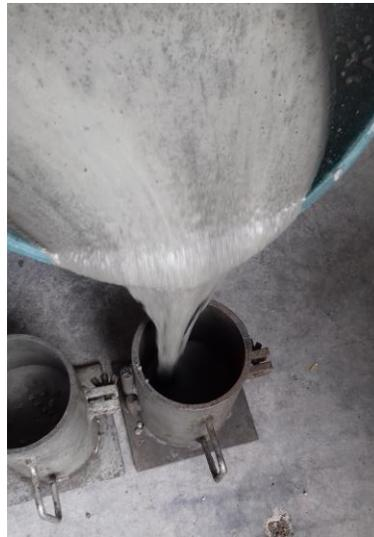
**b) Vaciado del mortero**
