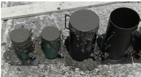
**Figura 2.9. Muestras cilíndricas para pruebas de laboratorio**
