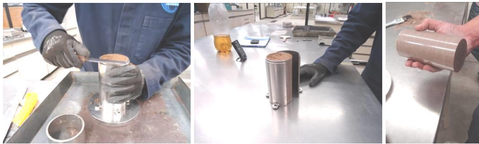
Figura 2.9. Enrase y extracción del espécimen de prueba.
