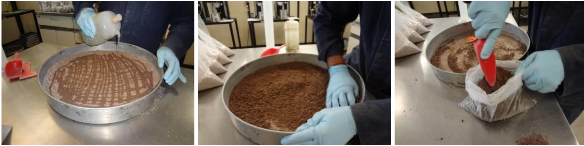
Figura 2.5. Proceso de humectación, mezclado y curado de muestras.
