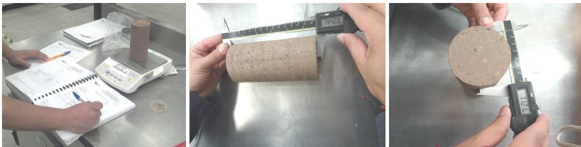
Figura 2.10. Pesaje y medición del espécimen compactado.
