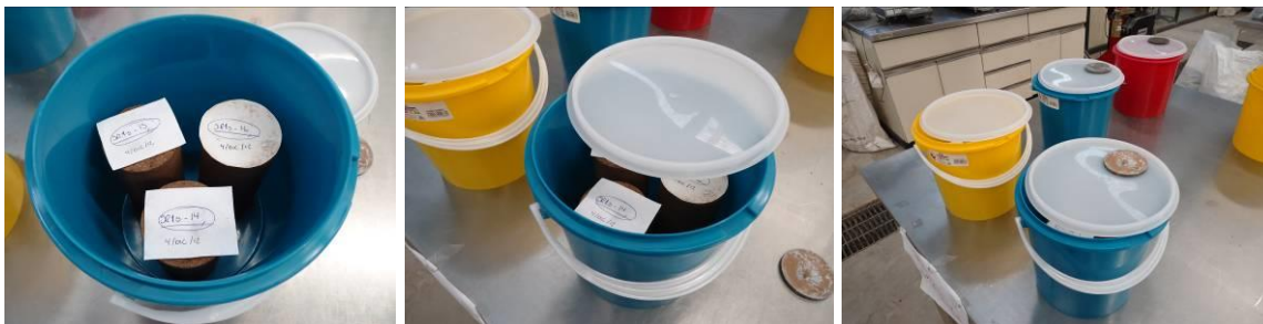
Figura 2.12. Acondicionamiento de especímenes (trayectoria de secado).
