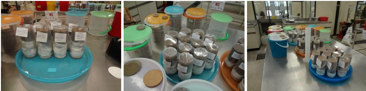
Figura 2.14. Acondicionamiento de especímenes (trayectoria de humedecimiento).
