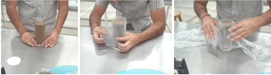
Figura 2.13. Preparación de especímenes para el proceso de humedecimiento.
