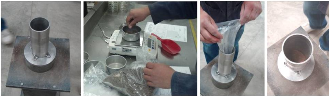
Figura 2.7. Pesaje y colocación del suelo en el molde de compactación.
