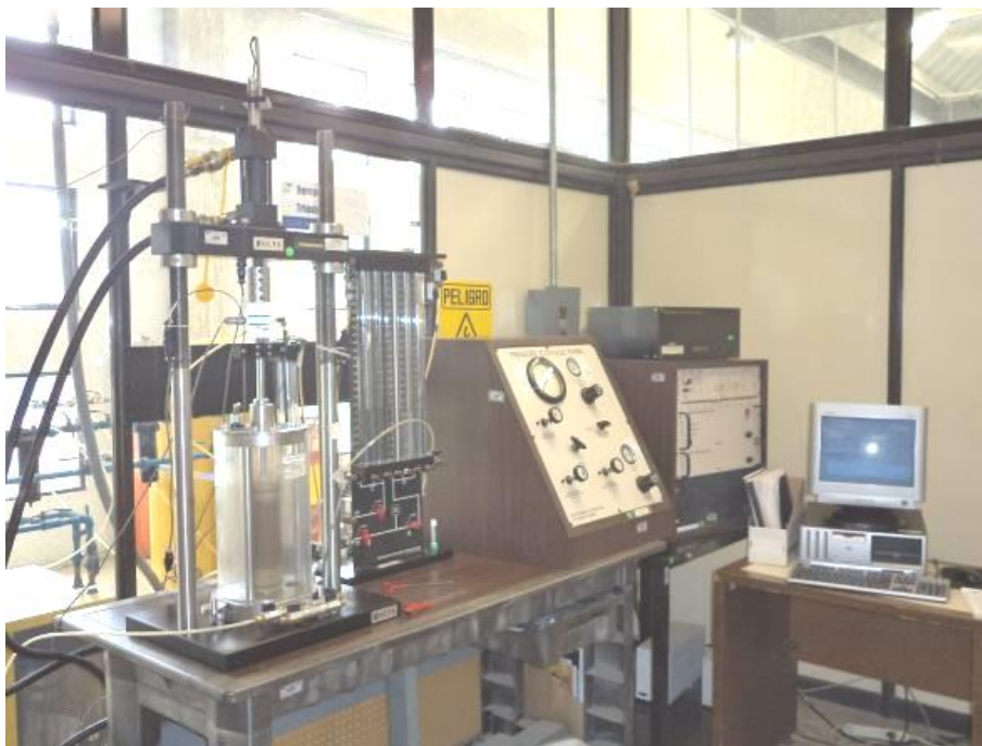
Figura 2.1 Unidades que componen el equipo triaxial cíclico.
