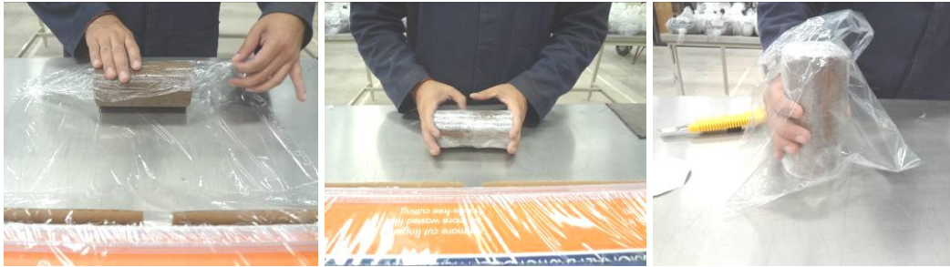
Figura 2.11. Empaque de especímenes compactados.
