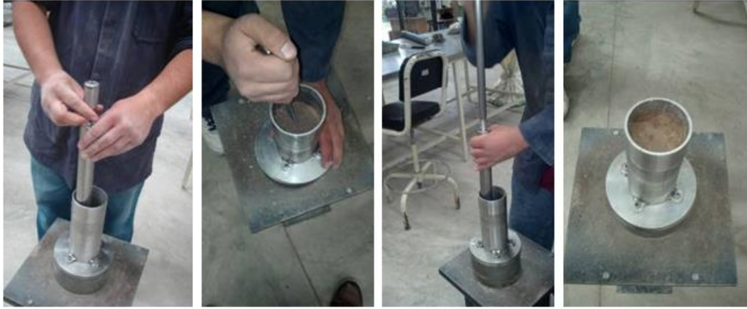
Figura 2.8. Proceso de compactación.
