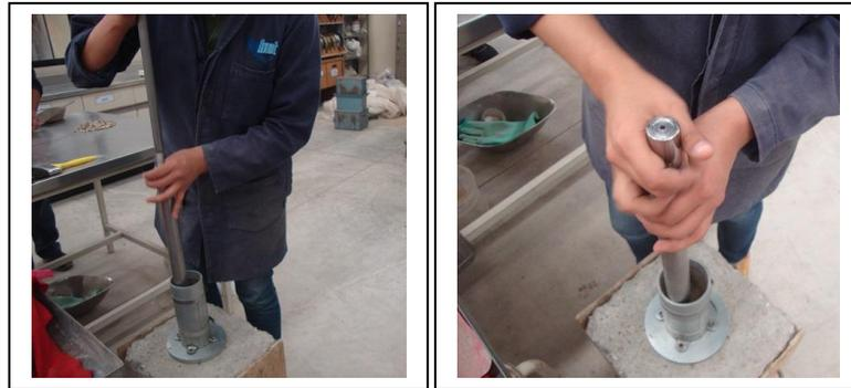
**Figura 2.7. Compactación de los especímenes en molde de 7.1 cm de diámetro por 14.4 cm de altura.**
