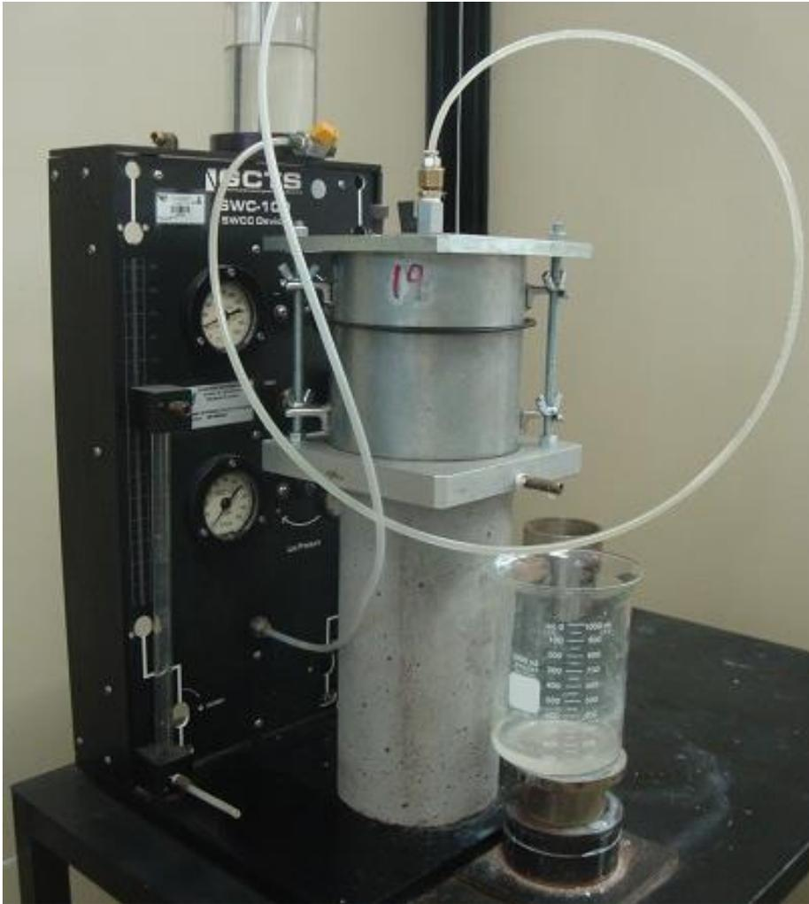
**Figura 2.12. Sistema para medir la permeabilidad.**
