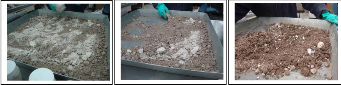
**Figura 2.3. Preparación de la mezcla suelo-5% de estabilizante y agua para alcanzar el contenido de agua óptimo**
