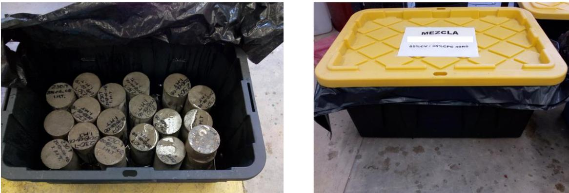
Figura 2.4. Condición húmeda en la que se mantuvieron las muestras de concreto.
