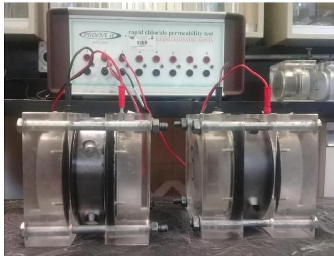
**Figura 2.8 Conexión de celdas a equipo de permeabilidad.**
