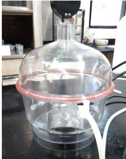
**Figura 2.7 Muestra de concreto colocada al vacío.**
