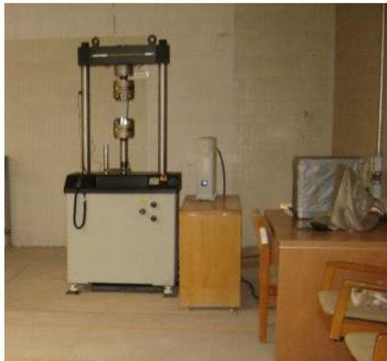
Figura 2.10 Máquina servohidráulica utilizada para los ensayos de resistencia a la compresión.
