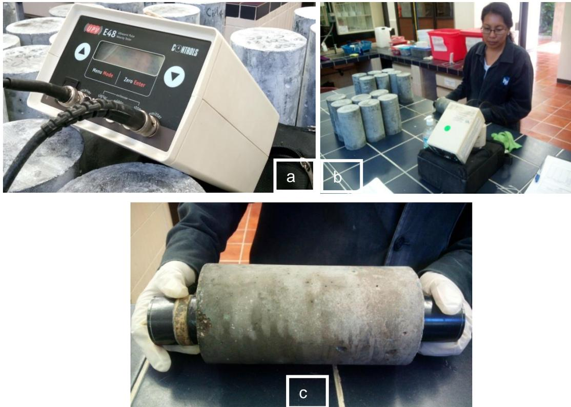
Figura 2.5. Ensayo de VPU: a) equipo VPU con respectivas conexiones, b) posición de los transductores en la muestra, y c) determinación de la velocidad de pulso.
