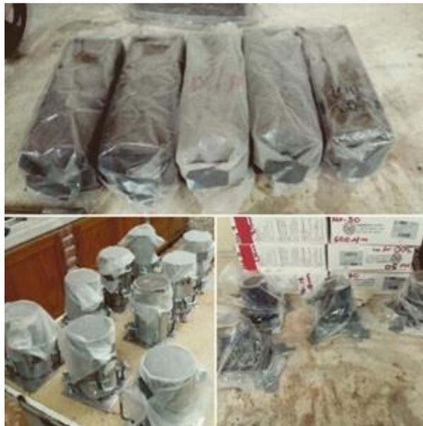
**Figura 2.1 Mezcla de mortero convencional colocada en moldes**
