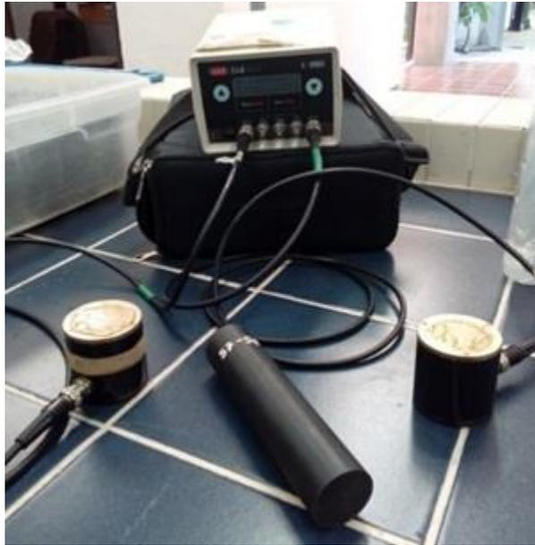
Figura 2.3 Equipo para realizar prueba de VPU
