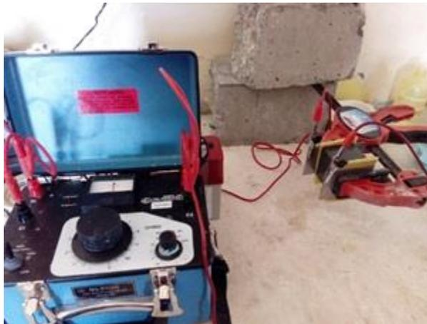
**Figura 2.2 Resistómetro utilizado para la prueba de resistividad en algunos especímenes**
