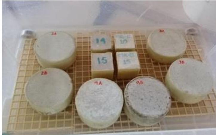
**Figura 2.6 Morteros de rodajas y cubos durante prueba con técnica de Fagerlund**
