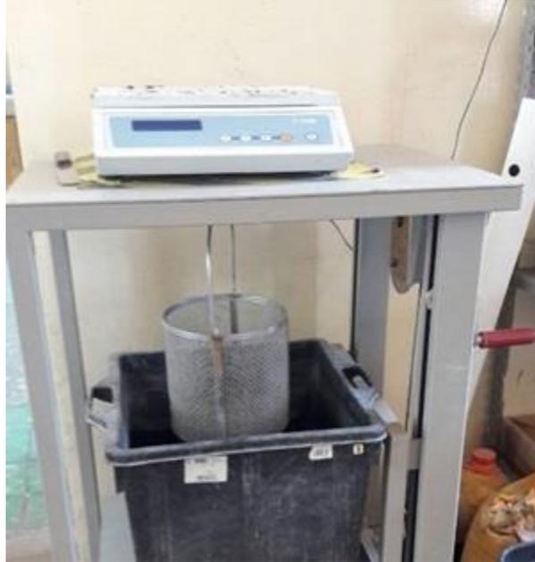
**Figura 2.5 Balanza utilizada para obtener peso sumergido de los especímenes**
