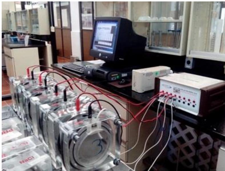
Figura 2.4 Ensayo de prueba PRC
