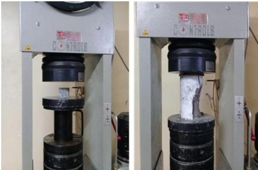
**Figura 2.7 Ensayos de resistencia a la compresión**
