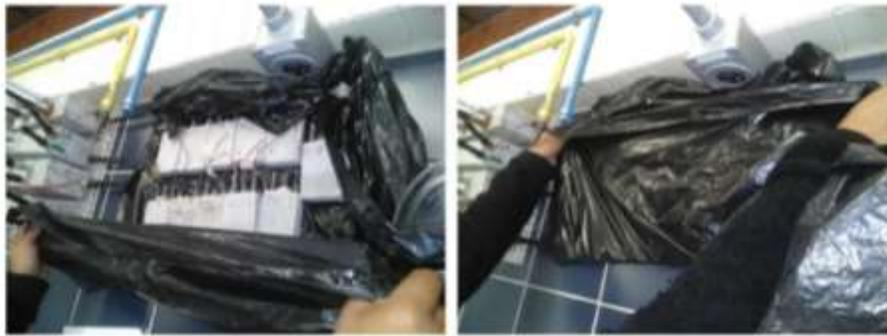
**Figura 2.2 Probetas prismáticas aisladas [24].**
