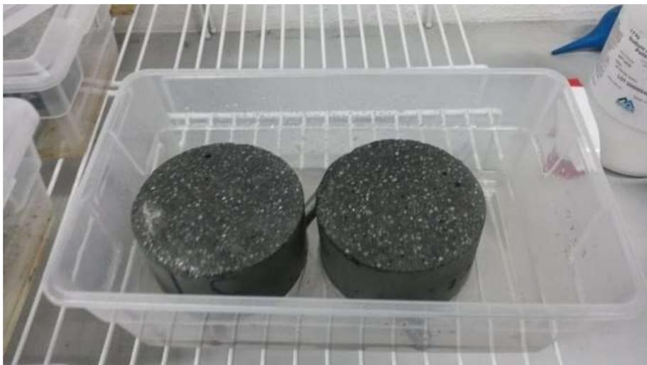
**Figura 2.14** Ensaye de absorción capilar
