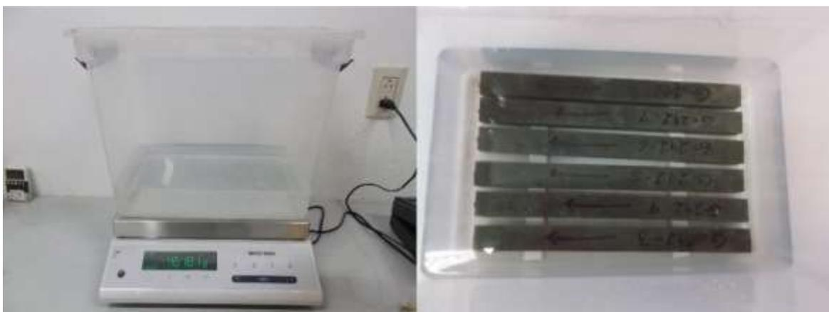
**Figura 2.10 Ensayo de resistencia a sulfatos.**
