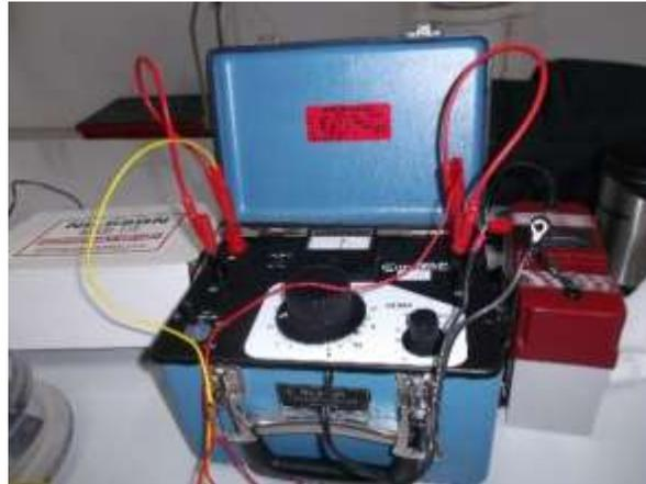
**Figura 2.7 Resistómetro Nilsson para prueba de resistividad en cubos**
