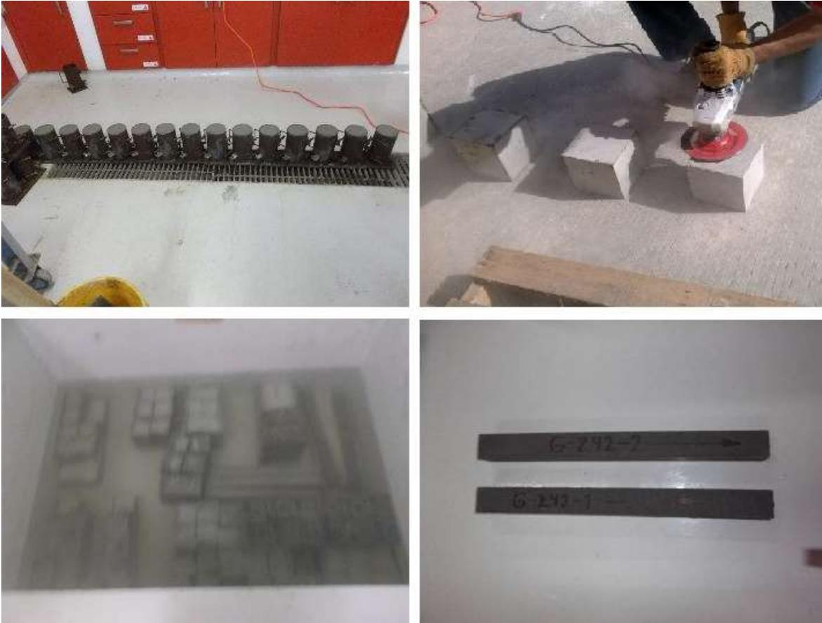
**Figura 2.1 Cilindros de mortero 10 x 20 cm, cubos de 15 x 15 cm, cubos de 5 X 5 cm y barras de mortero usadas en la experimentación.**
