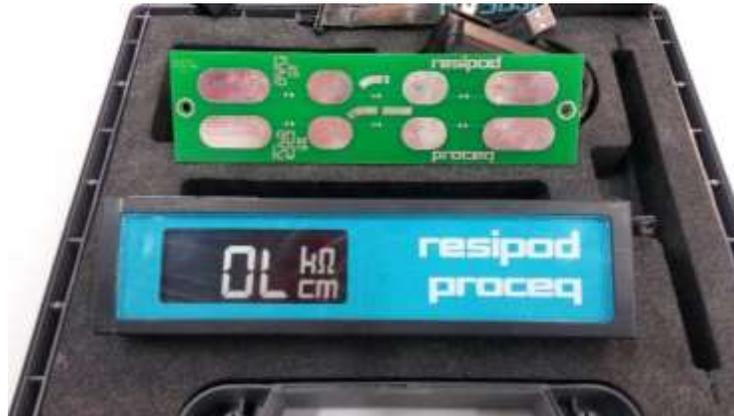
**Figura 2.8 Resistómetro Resipod para prueba de resistividad eléctrica en cilindros**
