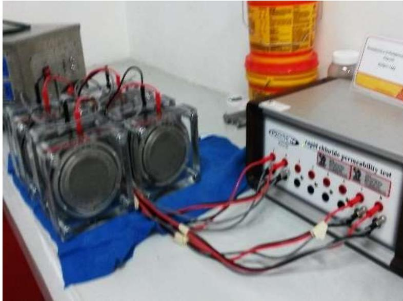
Figura 2.11 Ensayo de permeabilidad al ion cloruro
