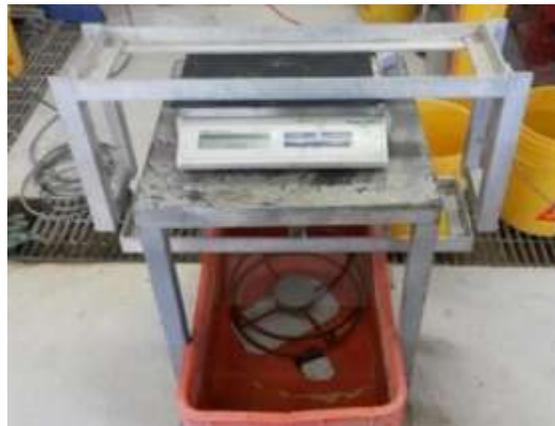
**Figura 2.13 Medición de peso saturado sumergido**
