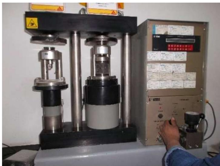
Figura 2.5 Ensayo de resistencia a la compresión
