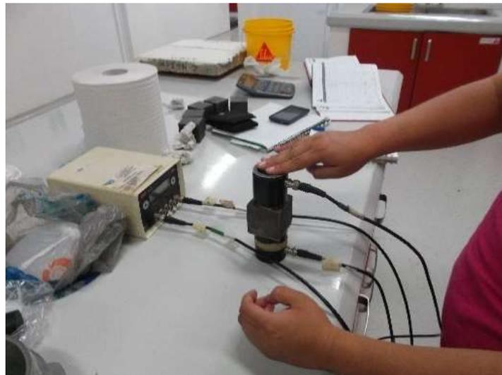
**Figura 2.9 Prueba de velocidad de pulso ultrasónico**
