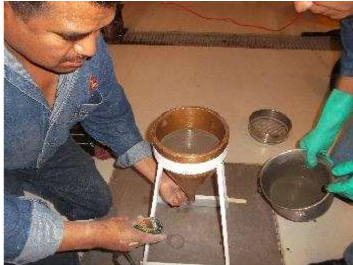
**Figura 2.2 Prueba de fluidez de morteros**
