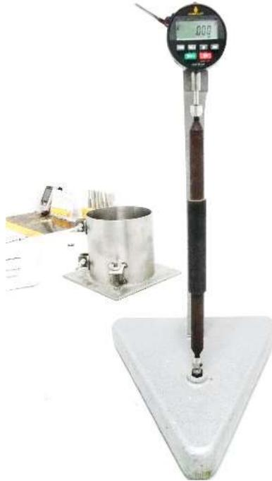
**Figura 2.6 Medición de cambios volumétricos**
