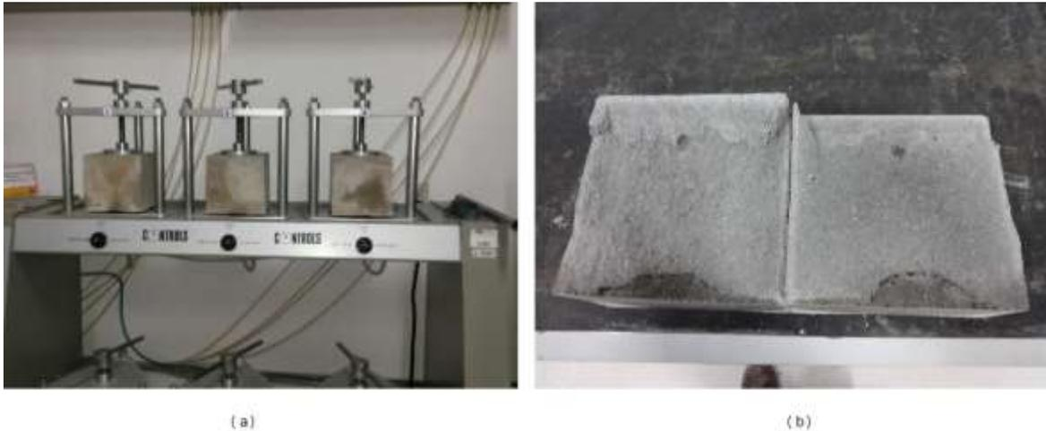
**Figura 2.12 a) Permeámetro, b) Verificación de profundidad de penetración de agua**
