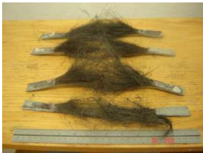
Figura 4.1 Probeta con diseño de acuerdo con la Norma y pegada con el epóxico 330 [8] durante el ensayo de tensión
