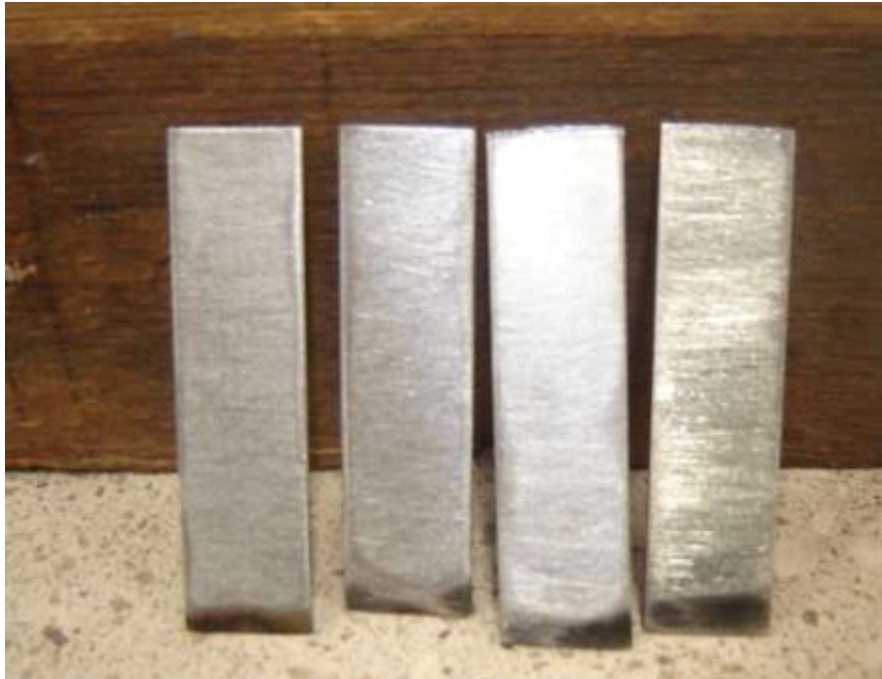
Figura 2.18 Laminillas de acero galvanizado de acuerdo con lo propuesto por Clifton [11] después de lijar con lija #80
