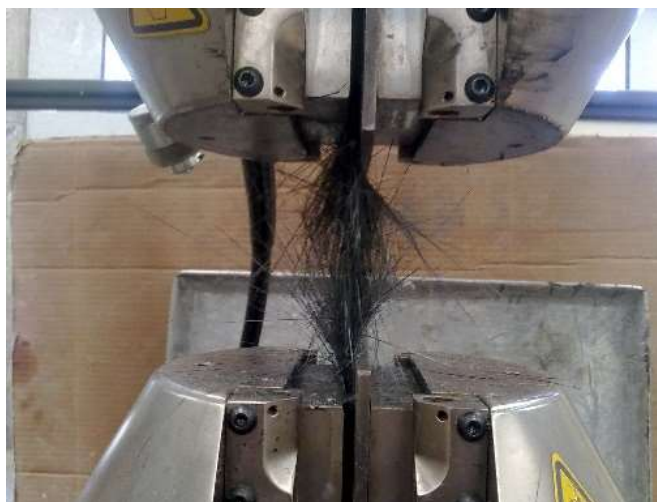
Figura 4.1 Probeta con diseño de acuerdo con la Norma y pegada con el epóxico 330 [8] durante el ensayo de tensión
