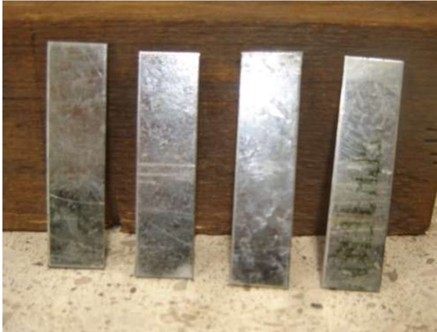
Figura 2.17 Laminillas de acero galvanizado de acuerdo a lo propuesto por Clifton [11] antes de lijar
