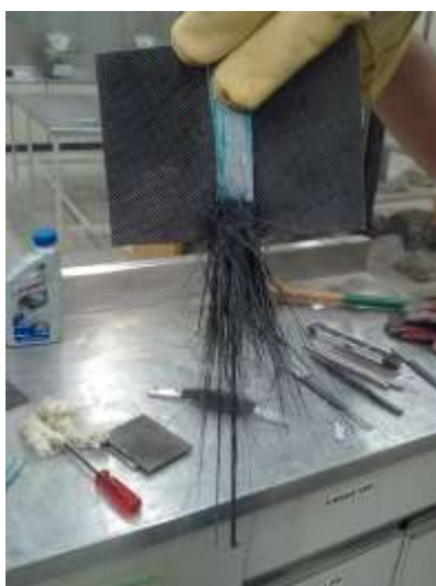
Figura 4.3 Probeta con diseño de acuerdo con la Norma y pegada con el epóxico 35 [9] después de fallar
