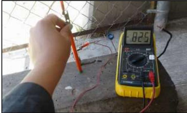
**Figura 2.4. Medición de potencial de ánodo.**
