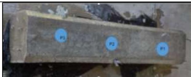
**Figura 2.3 a) Ubicación de los puntos de medición del potencial de corrosión**
