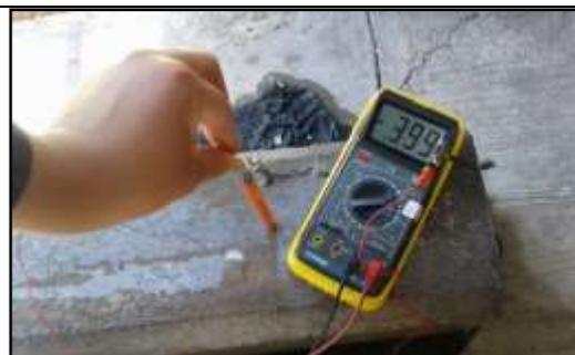
**Figura 2.3 b) Medición de potencial de acero de refuerzo**
