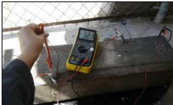
**Figura 2.5. Medición de potencial de protección.**
