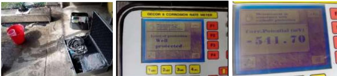
**Figura 3.5. Muestra el uso de Gecor 8 para medir la efectividad de la protección catódica.**
