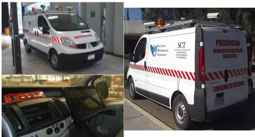
**Figura 2.4: Vehículo equipado para la toma de imágenes por video de la red vial**
