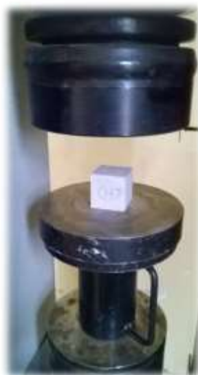
Figura 12. Prueba de resistencia a la compresión de pastas
