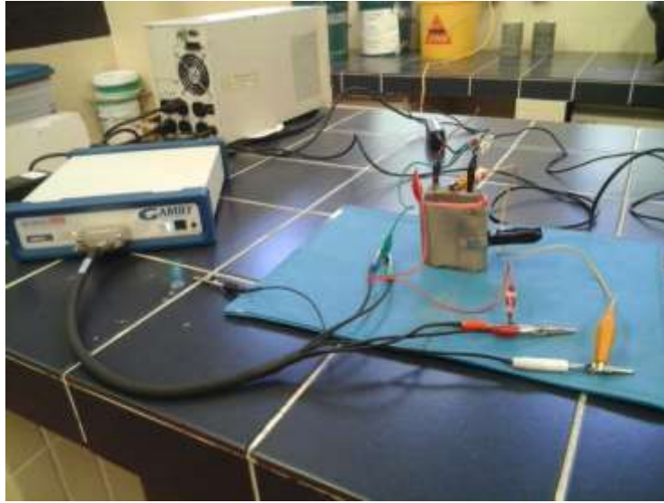
Figura 15. Esquema de conexión de la celda electroquímica
