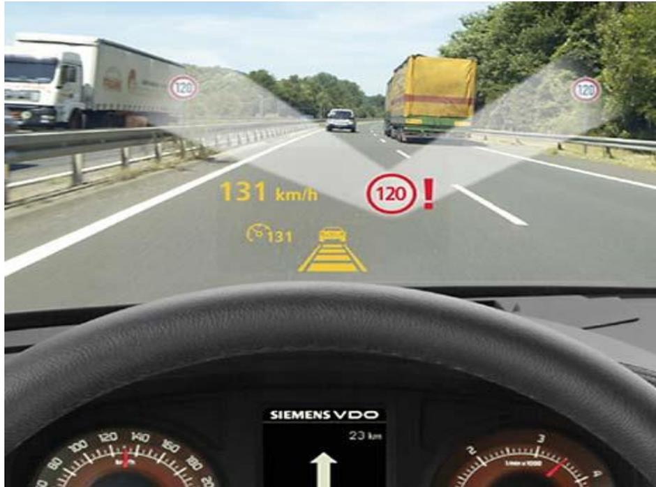
**Figura 5.1 Funcionamiento del Sistema de Asistencia de Velocidad**
