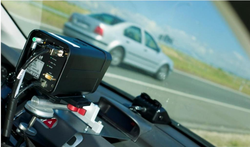
**Figura 5.19** Cámara móvil montada en el interior del vehículo de policía
