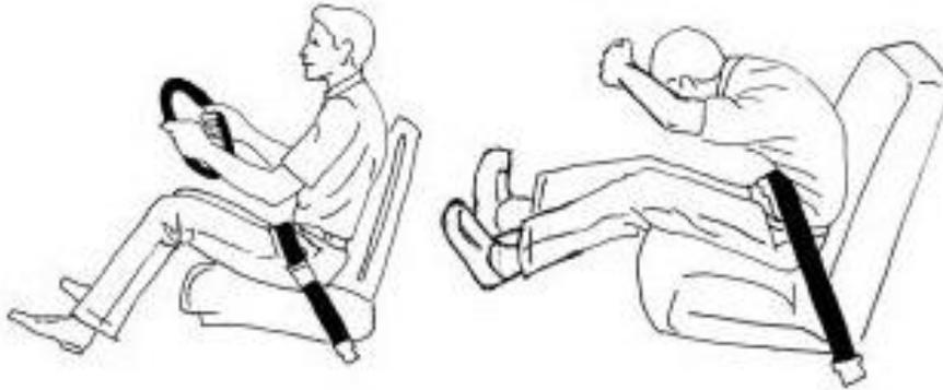
**Figura 3.2 Efecto de latigazo del cinturón de seguridad de 2 puntos**
