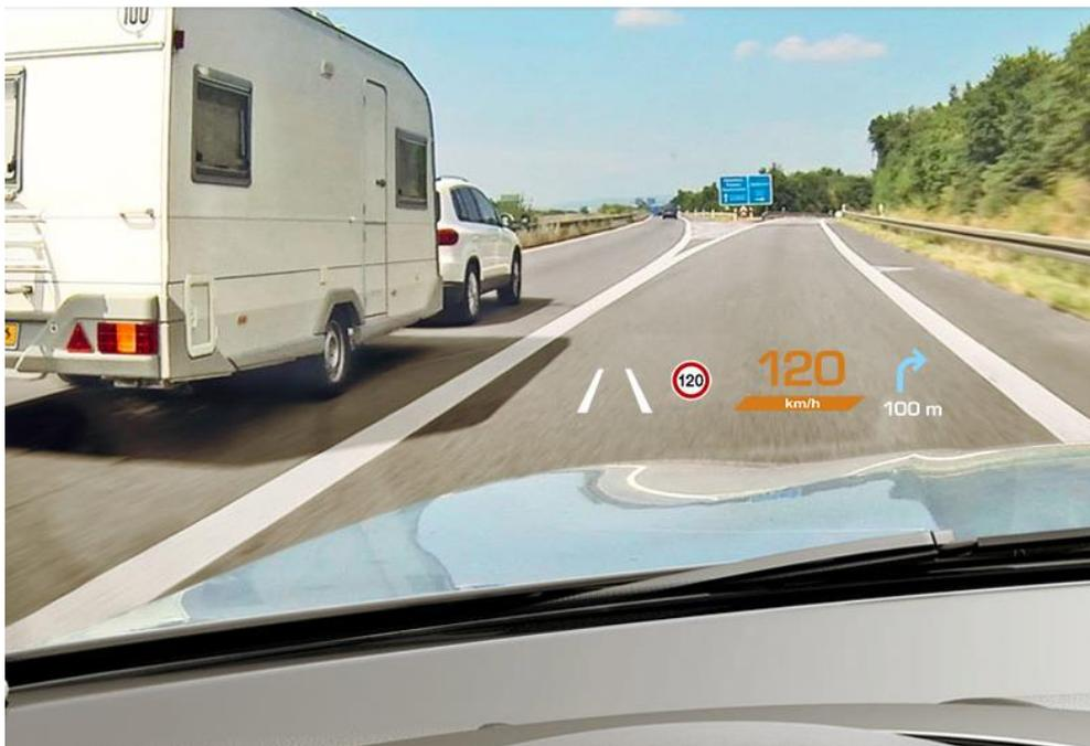
**Figura 5.21 Información de velocidad y señalamiento proyectada en el parabrisas del vehículo**
