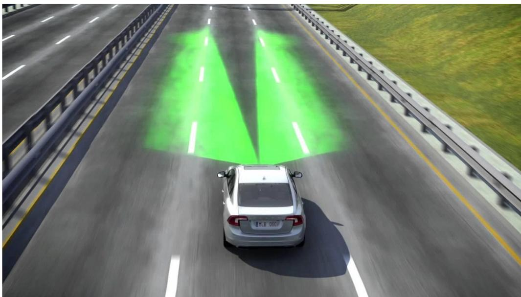
**Figura 5.4 Funcionamiento del Sistema de Advertencia de Salida de Carril**
