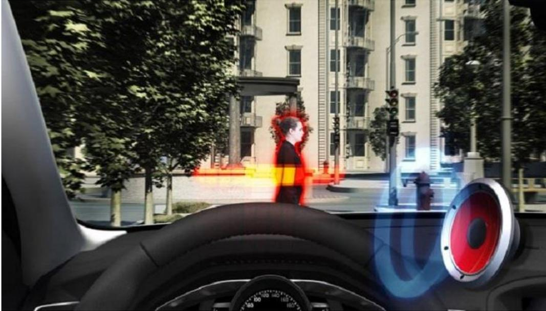
**Figura 5.16 Sistema de detección de peatones dentro del vehículo**
