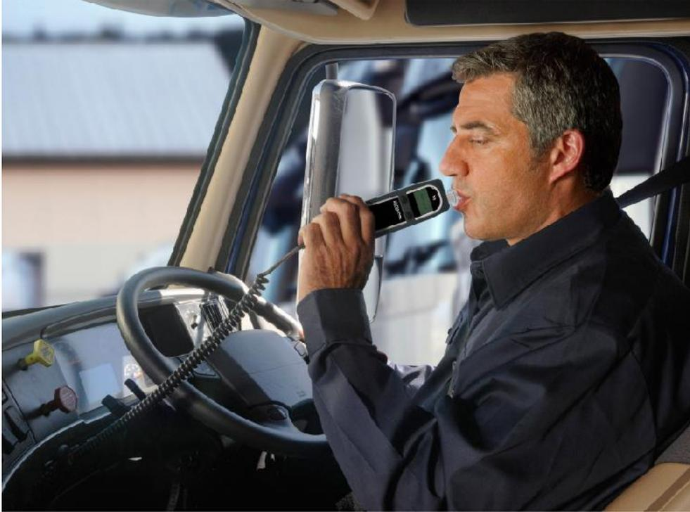
**Figura 5.7 Utilización del “alcolock”**
