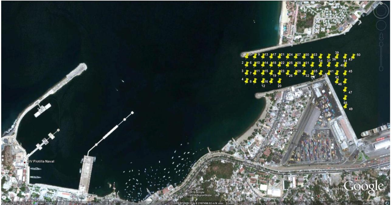
**Figura 1.1** Puntos de modelación del Puerto de Manzanillo para rapidez máxima y media de corrientes en el *Proyecto de investigación VI-17/13*
