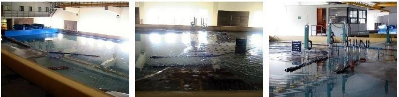
**Figura 1.2** Modelo hidráulico a escala del Puerto de Manzanillo, utilizado en el *Proyecto de investigación VE-12/13* que aportó datos para el *Proyecto de investigación VI-17/13*
