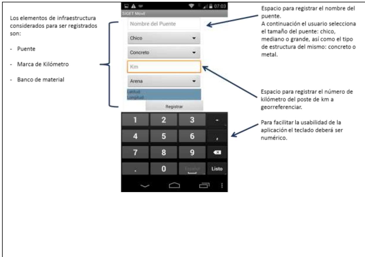
Figura 2.7 Pantalla con formulario de captura para estructuras de tipo Puente, Marca de KM y Banco de material
