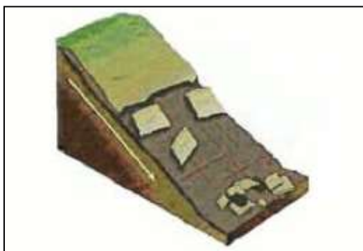
Figura 2.17 Esquema de un deslizamiento planar. (Internet: www.google.com/imagenes )
