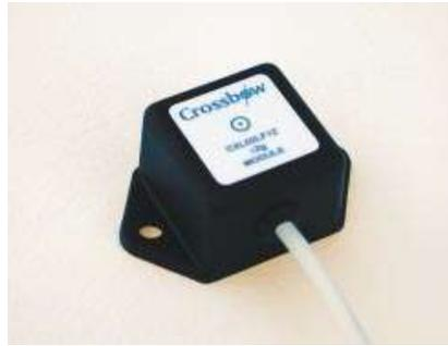
**Figura 11. Acelerómetro capacitivo Crossbow CXL01LF14**
