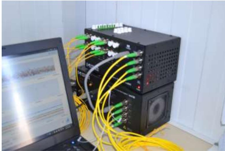
**Figura 30. Interrogador y multiplexor para fibra óptica instalados en caseta de monitoreo**
