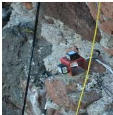
**Figura 22. Acelerómetros Crossbow en pila 28**
