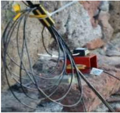
**Figura 20. Acelerómetros Crossbow en pila 26**
