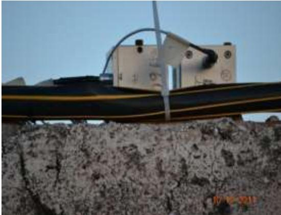
**Figura 18. Acelerómetros CBM arco 26-27**
