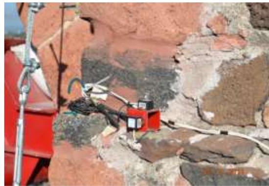
**Figura 21. Acelerómetros Crossbow en pila 27**
