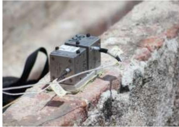
**Figura 19. Acelerómetros CBM arco 27-28**
