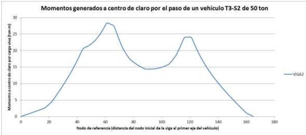
En el caso de que se encuentre un segundo vehículo sobre el puente se considera el mismo avance que para el vehículo T3-S2 para obtener la magnitud del segundo ciclo de carga.
