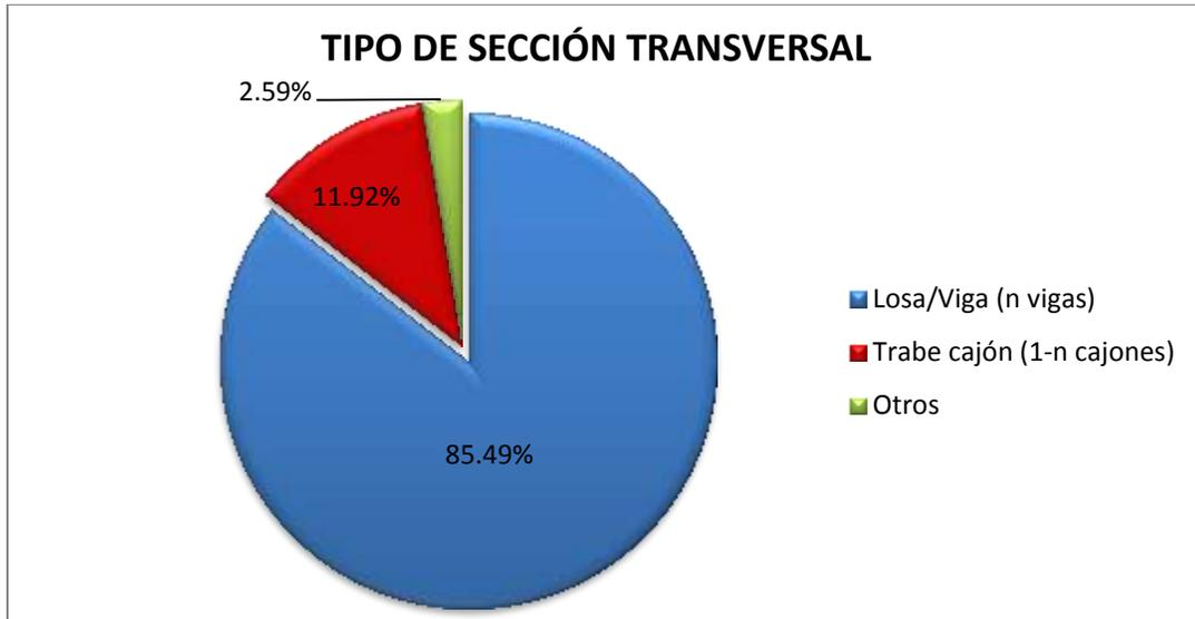
Se observa que predominan los puentes con la configuración losa-viga, así que de ellos se determinan finalmente las características geométricas.
