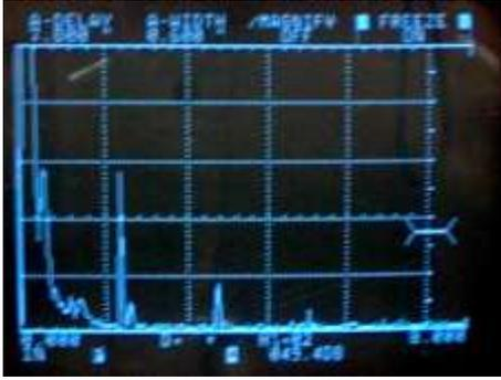
(a) Reflejo de pared posterior de un material con tamaño de grano grueso (ASTM 1 y 2).
