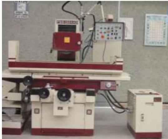
**Figura 21. Rectificadora de superficies planas**
