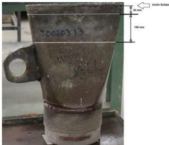
**Figura 17. Corte del elemento de anclaje superior**
