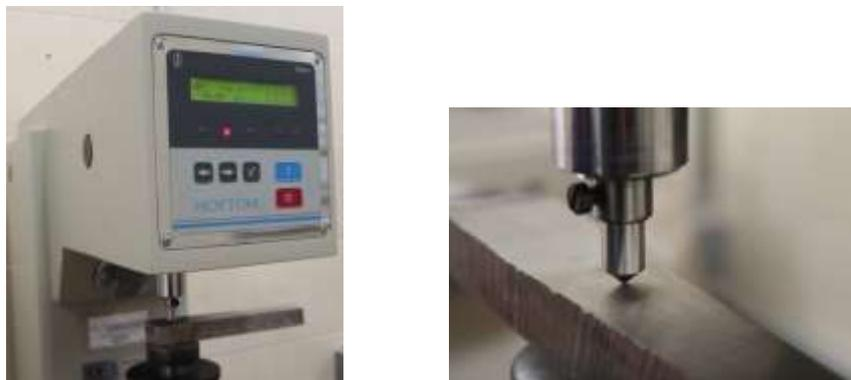
**Figura 22. Durómetro Hoytom modelo 713 FR**
