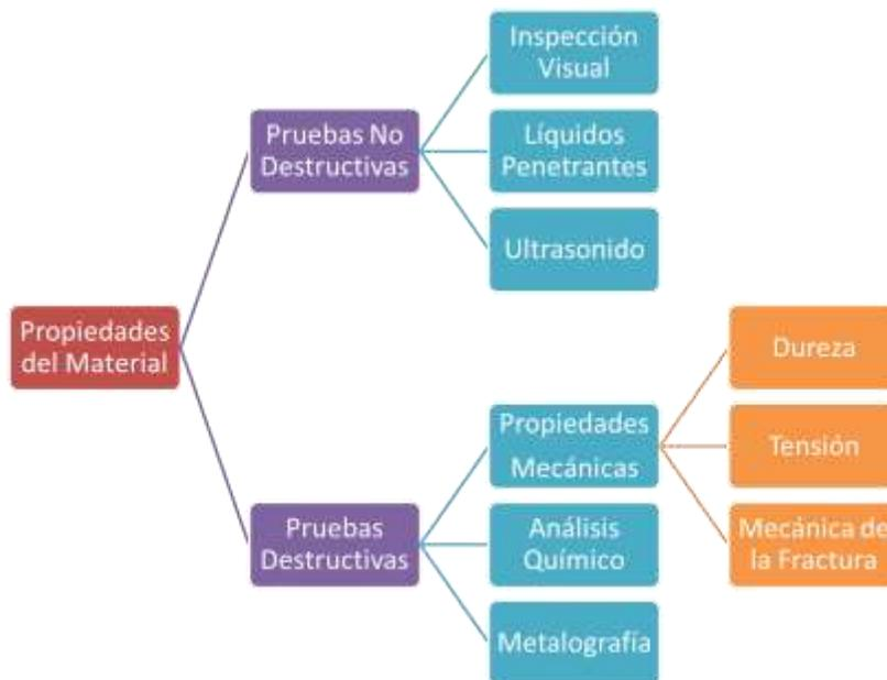
**Figura 4. Metodología para determinar el comportamiento estadístico de las propiedades mecánicas de elementos de acero estructural**
