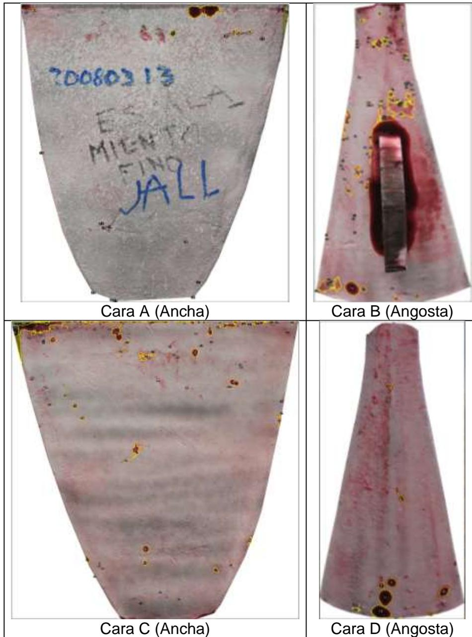
**Figura 34. Indicaciones de discontinuidades del elemento de anclaje EN-20080313-001**
