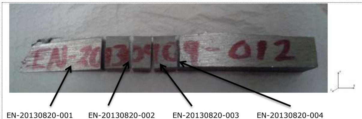
**Figura 50. Muestras para las pruebas metalográficas**
