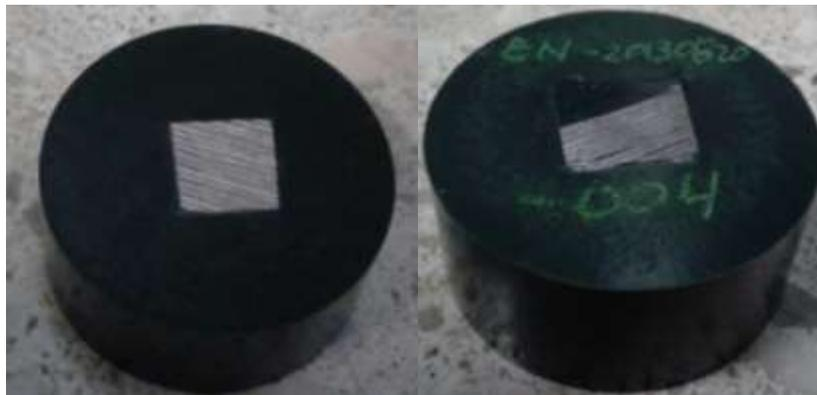
**Figura 51. Muestras montadas en baquelita**
