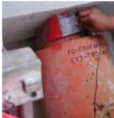
**Figura 12. Inspección por ultrasonido de un elemento de anclaje superior**
