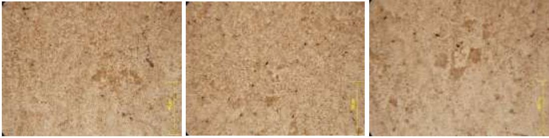
**Figura 52. Tamaño de grano fino entre 7 y 8 de acuerdo a la norma ASTM E112 <sup>[17]</sup>**
