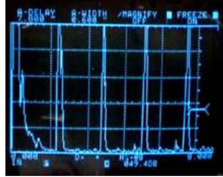
(b) Reflejo de pared posterior de un material con tamaño de grano fino (ASTM 7 y 8).
