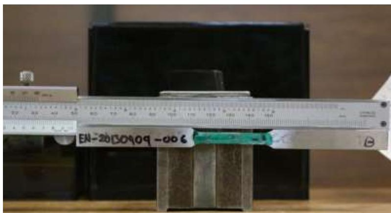
**Figura 40. Medición de la longitud final**
