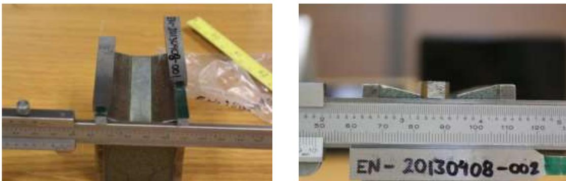
**Figura 41. Medición de la longitud y área final**
