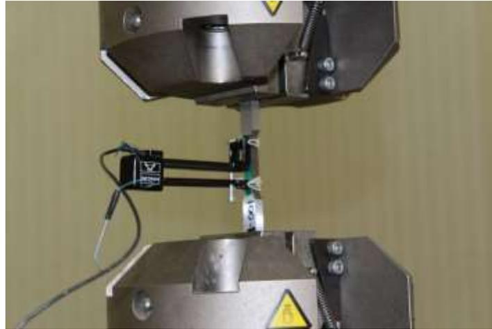
Figura 25. Dispositivo de sujeción y extensómetro
