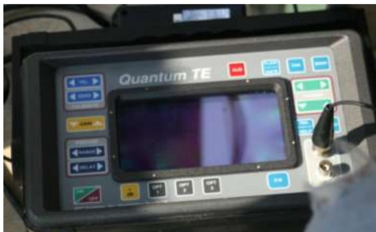
**Figura 19. Equipo de ultrasonido Quantum-TE de NDT Systems**
