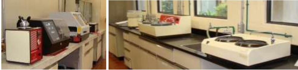
**Figura 30. Equipo para preparación metalográfica**
