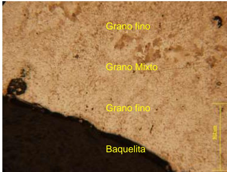
**Figura 54. Cambio de la microestructura de la probeta EN-20130820-001**
