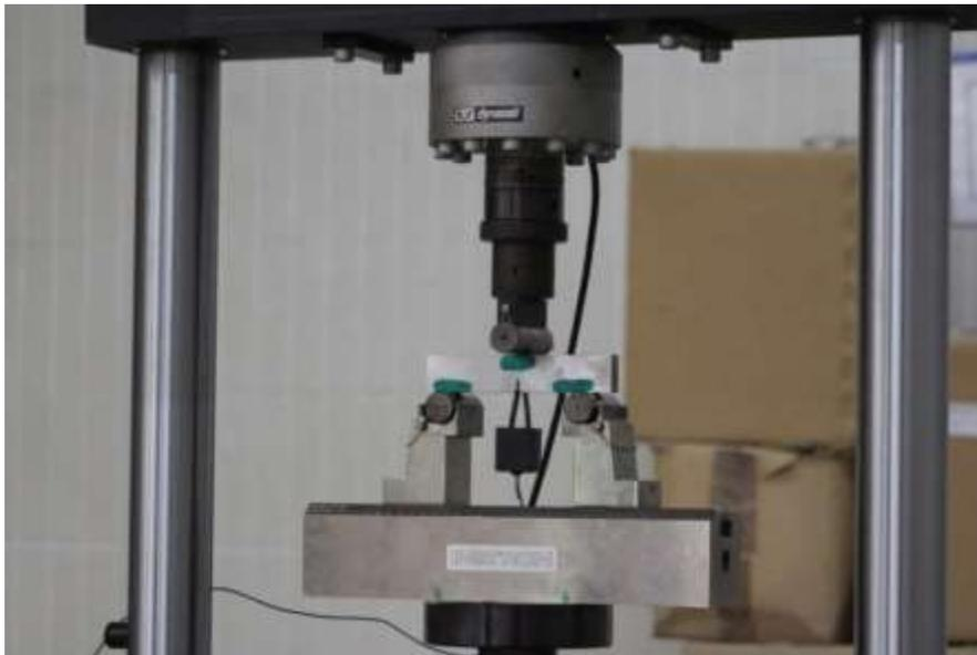
**Figura 27. Configuración de la prueba de velocidad de crecimiento de grieta**
