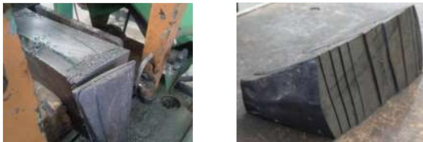
**Figura 20. Corte de probetas con la sierra cinta horizontal**
