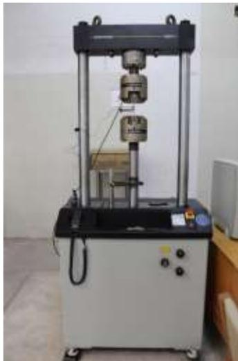
**Figura 24. Maquina servo hidráulica Instron 8801**
