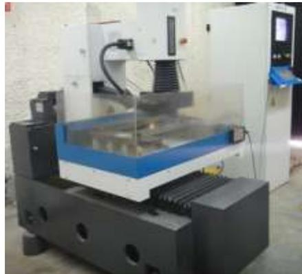
**Figura 23. Electroerosionadora**
