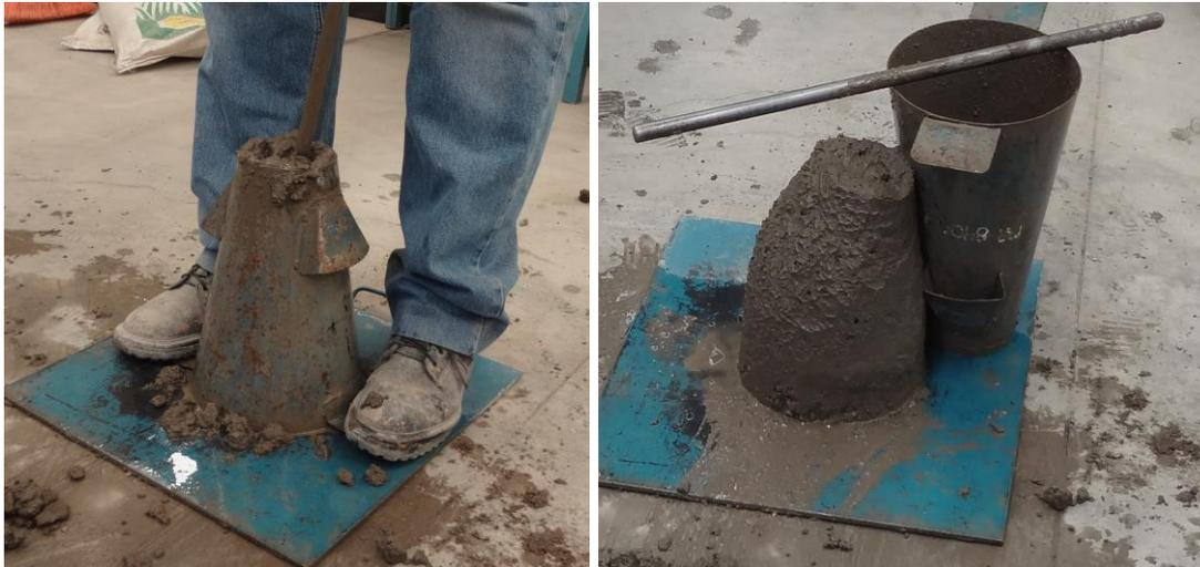
**Figura 4.- Prueba de revenimiento**
